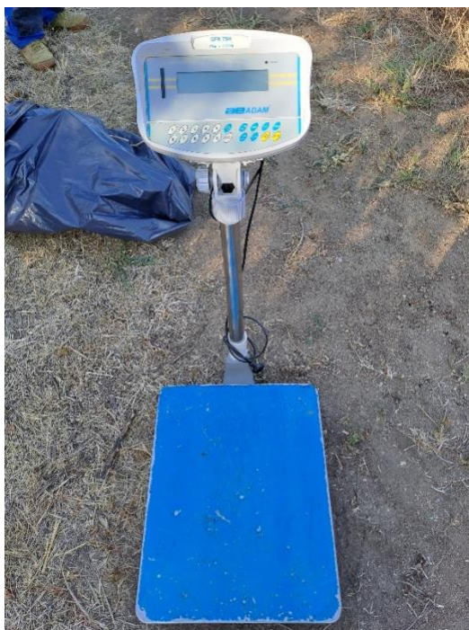
Εικόνα 6. Ζυγαριά ακριβείας που χρησιμοποιήθηκε για την μέτρηση του ολικού βάρους του δείγματος της τελικής κοπής.
