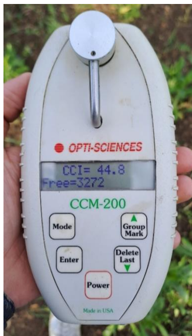
Εικόνα 4. Μετρητής φωτοσυνθετικής ικανότητας που χρησιμοποιήθηκε για την μέτρηση της συγκέντρωσης χλωροφύλλης των φύλλων.
