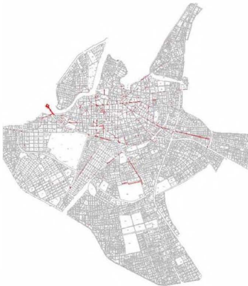
Εικόνα 17. Δίκτυο ύδρευσης Λάρισας από σωλήνες φαιού χυτοσίδηρου
