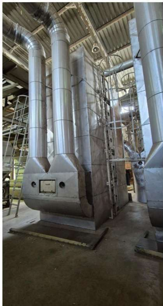
Εικόνα 3.2: Διάταξη πύργων ξήρανσης σύσπορου βάμβακος (αριστερά) – Καυστήρας υγραερίου (δεξιά)
