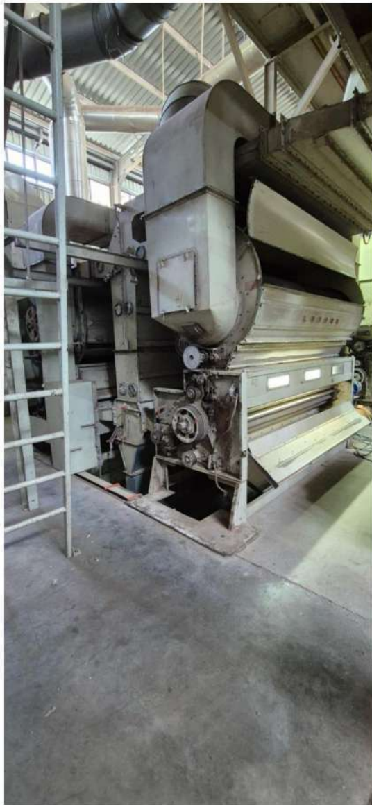
Εικόνα 3.5: Lint cleaner Lummus 108 (αριστερά) – Αξονικοί απορροφητήρες Lint cleaner (δεξιά)
