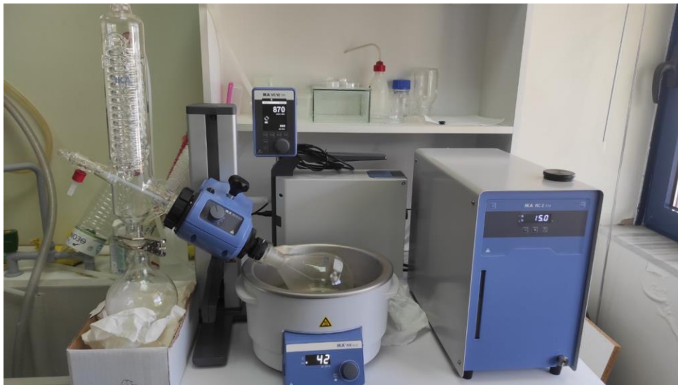
Εικόνα 17. Απεικόνιση του οργάνου Rotary Evaporator που χρησιμοποιήθηκε στο πρωτόκολλο εκχύλισης δευτερογενών μεταβολιτών (MAA).
