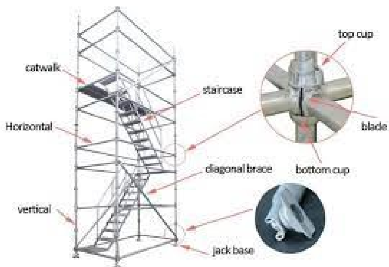
Εικόνα 4 [5. Σκαλωσιά με cuplock]
