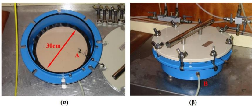
Σχήμα 3.3 : Μέθοδος προσδιορισμού μύζησης με τη μέθοδο θαλάμου μύζησης. (Μπαρδάνης & Καββαδάς, 2005)
