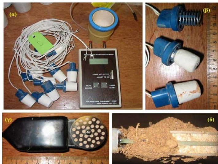
Σχήμα 3.7 : Ύψος και σύστημα μέτρησης για τον προσδιορισμό της μύζησης (α) τμήματα γύψου (β) πορώδες υλικό (γ) τα ίδια μετά την ολοκλήρωση της μέτρησης στο πεδίο. (Μπαρδάνης, 2016)
