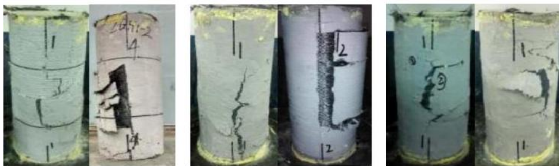
Σχήμα 2.20: Αστοχία περισφιγμένων δοκιμών υποβαλλόμενων σε: (α) 100°C, (β) 200°C και (γ) 300°C (Zhang et al. 2016).
