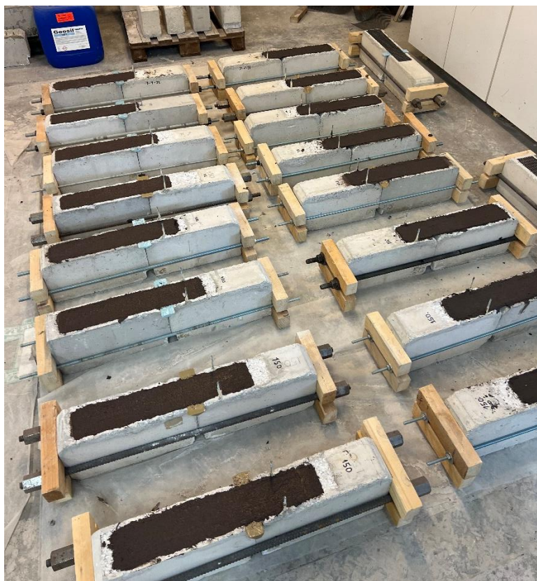
Σχήμα 3.8: Συντήρηση δοκιμίων στο χώρο του εργαστηρίου.
