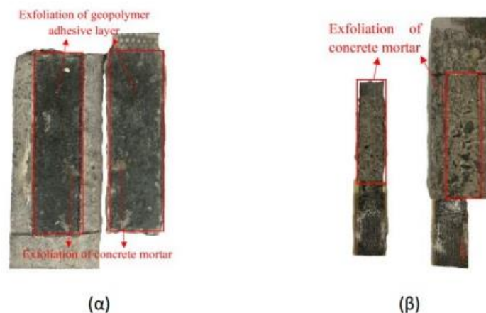
Σχήμα 2.25: Εικόνες αστοχίας δοκιμών (α) με γεωπολυμερές κονίαμα, (β) με ρητινούχο κονίαμα (Liu et al.2022).
