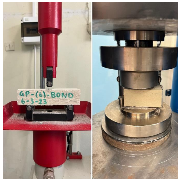
Σχήμα 3.5: α) Μηχανή κάμψης τριών σημείων, β) Μηχανή σύνθλιψης.
