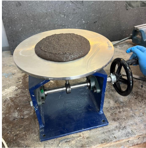
Σχήμα 3.3: Μέτρηση εργασιμότητας με τη μέθοδο του δίσκου εξάπλωσης
