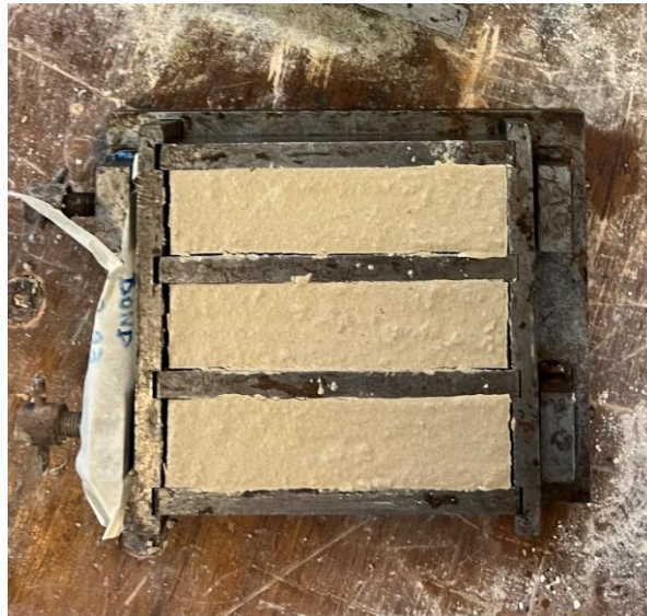
Σχήμα 3.4: Δειγματοληψία κονιάματος σε μεταλλικές μήτρες.
