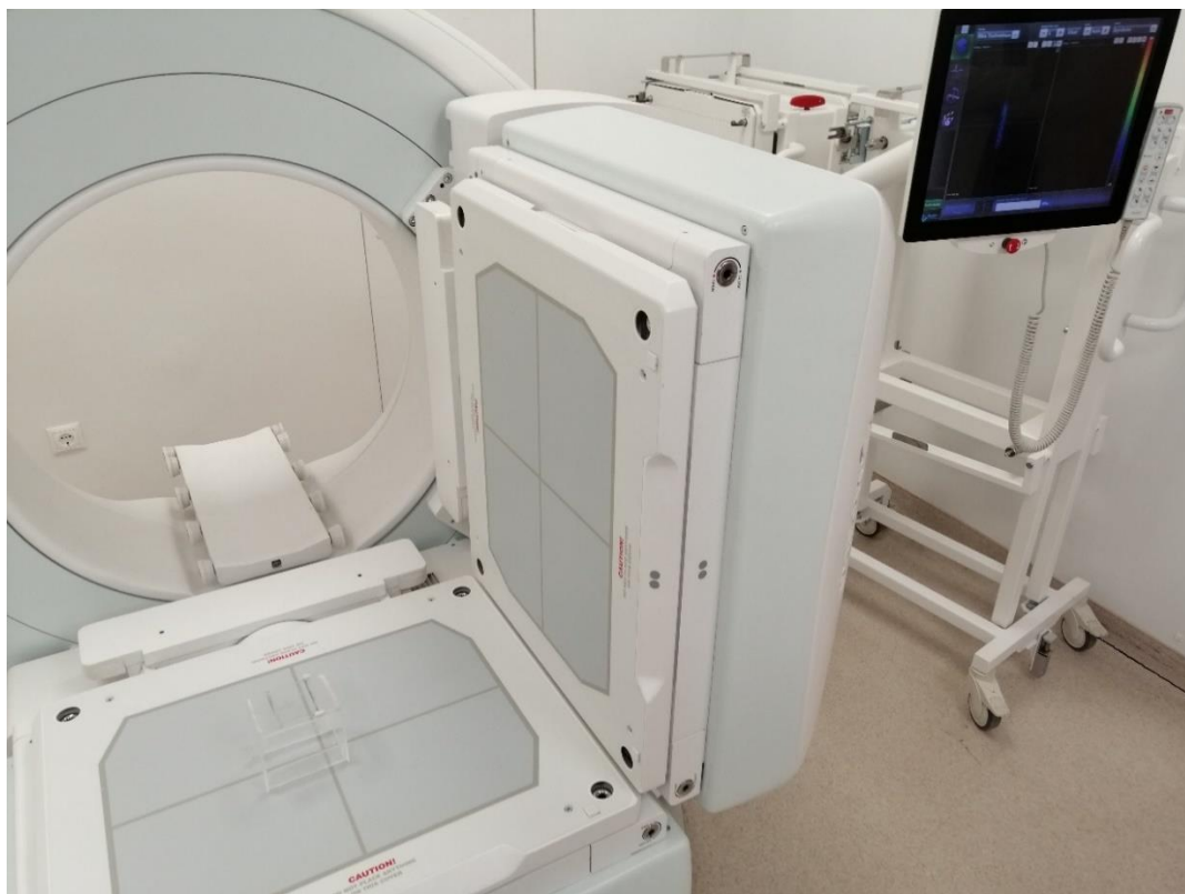
Εικόνα 30. Απεικόνιση της διάταξη των ανιχνευτών και της τοποθέτησης του υποδοχέα με το τριχοειδές σωληνάριο πάνω στον κατευθυντήρα της κεφαλής κατά τον άξονα X του συστήματος.
