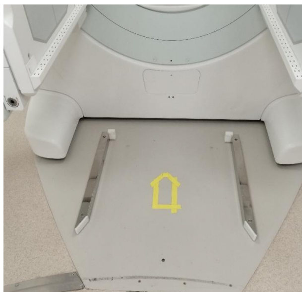
Εικόνα 4. Η σήμανση του σωστού σημείου τοποθέτησης του υποδοχέα πηγής στην βάση του συστήματος, διασφαλίζει την σωστή θέση της σημειακής πηγής σε κάθε μέτρηση.
