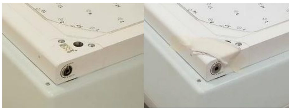
Εικόνα 14 . Πριν την τοποθέτηση του linearity phantom πάνω στον ανιχνευτή, οι επαφές σύνδεσης για τους κατευθυντήρες θα πρέπει να καλύπτονται με κάποιο μαλακό υλικό.
