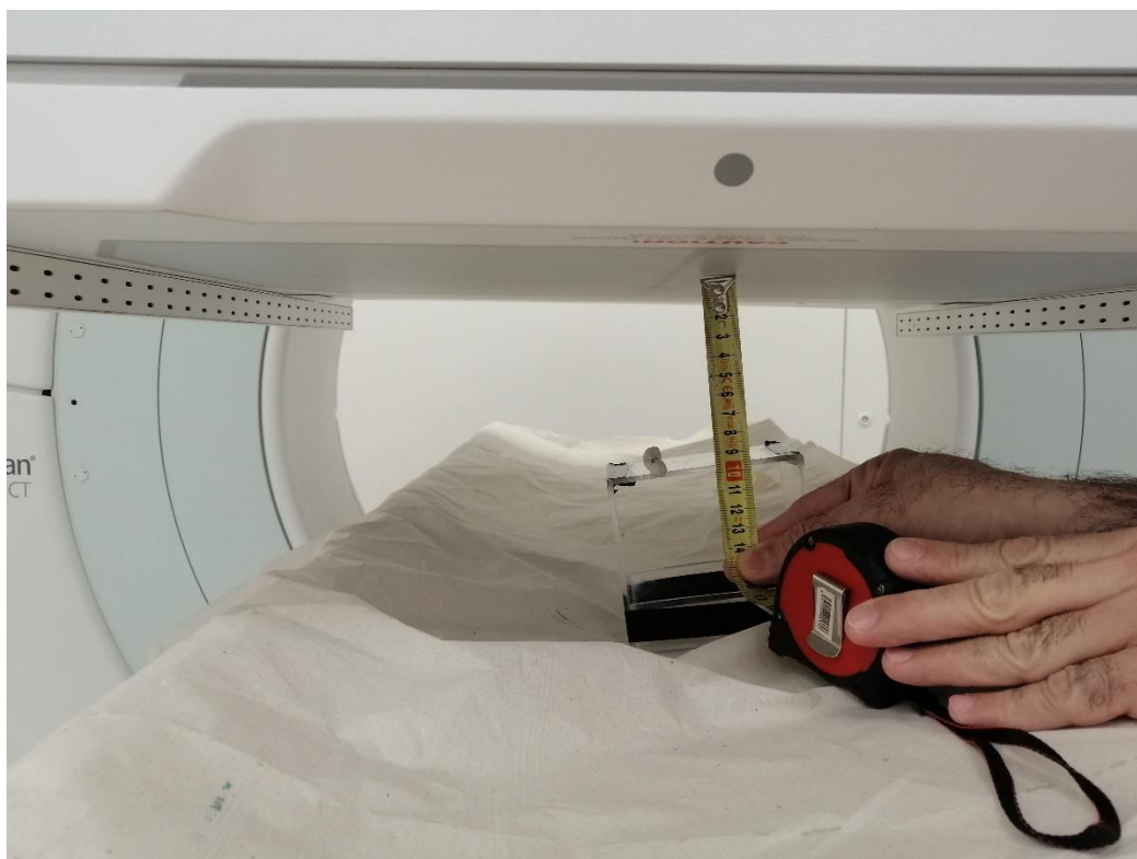
Εικόνα 36. Απεικόνιση της τοποθέτησης του υποδοχέα με το τριχοειδές σωληνάριο πάνω στο κρεβάτι. Η απόσταση από την επιφάνεια του ανιχνευτή προς μέτρηση, πρέπει να είναι 10 cm.
