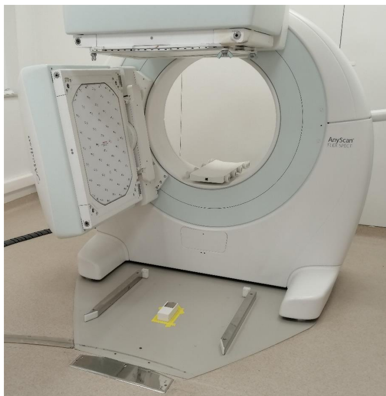
Εικόνα 10. Η διάταξη των ανιχνευτών και του υποδοχέα πηγής για τον έλεγχο εσωτερικής ομοιογένειας του προς μέτρηση ανιχνευτή.
