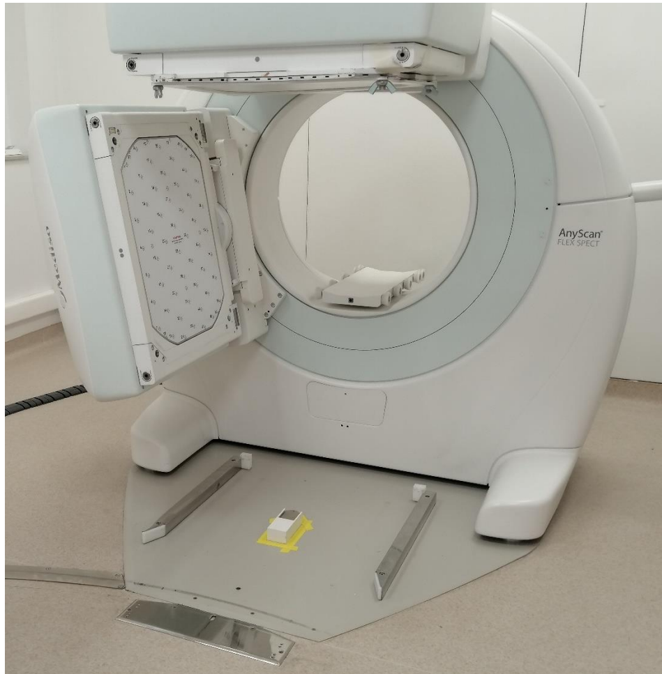
Εικόνα 17. Διάταξη ανιχνευτών και υποδοχέα πηγής για τον έλεγχο εσωτερικής χωρικής διακριτικής ικανότητας και γραμμικότητας.
