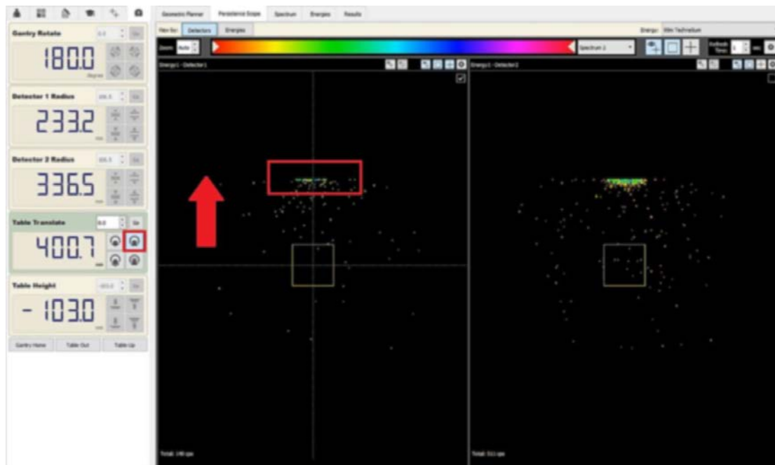
Εικόνα 38. Στιγμιότυπο από το Detector View. Επαλήθευση της σωστής τοποθέτησης της πηγής για την εκκίνηση του ελέγχου.
