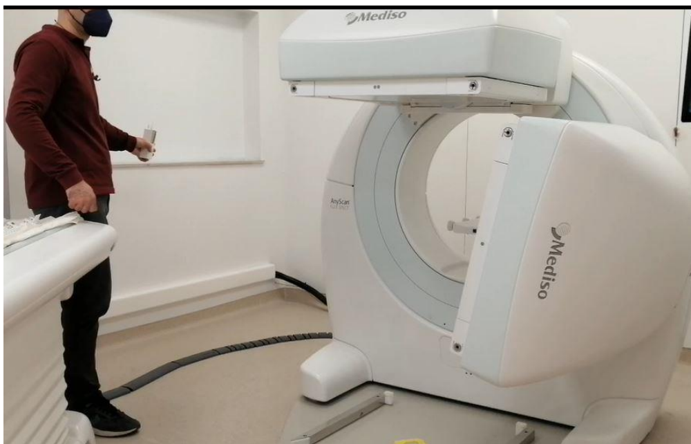
Εικόνα 25. Η αρχική θέση της πηγής για τον έλεγχο μέγιστου ρυθμού κρούσεων.
