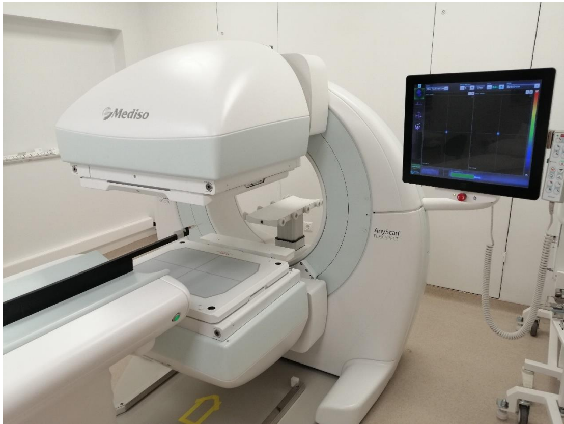
Εικόνα 45. Απεικόνιση της τοποθέτησης του υποδοχέα πηγής για τον έλεγχο του κέντρου περιστροφής σε διαμόρφωση 180^\circ . Η σωστή θέση της πηγής επιβεβαιώνεται από το Detector View στην οθόνη του Gantry.
