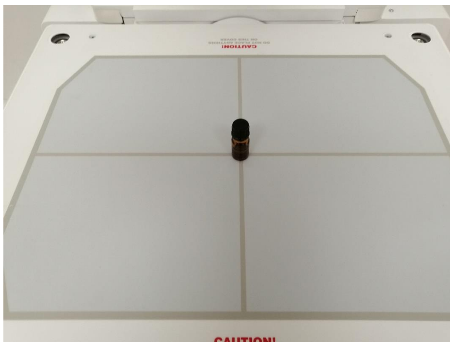
Εικόνα 40. Απεικόνιση της τοποθέτησης του φιαλιδίου στο κέντρο του κατευθυντήρα του ανιχνευτή προς μέτρηση.
