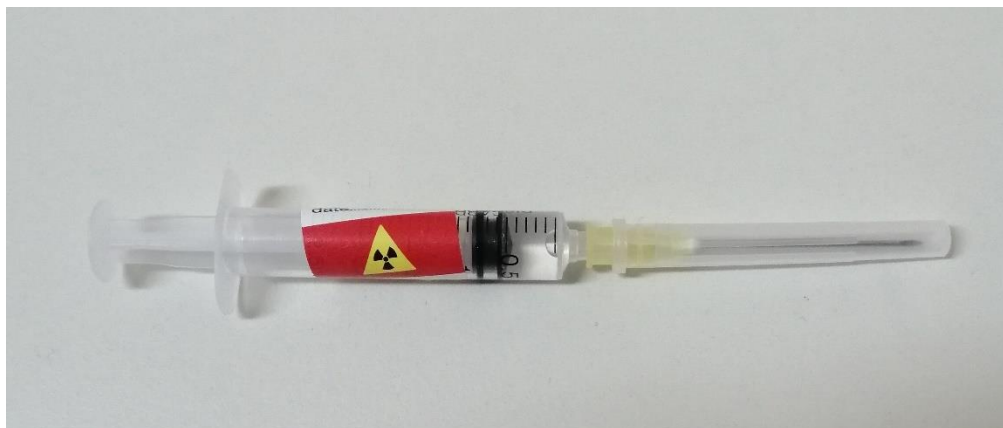
Εικόνα 2. Η σημειακή πηγή που χρησιμοποιείται στους ελέγχους: 0,5 ml διαλύματος Tc99 σε σύριγγα 2ml. Η ενεργότητα του διαλύματος εξαρτάται από τον κάθε έλεγχο.
