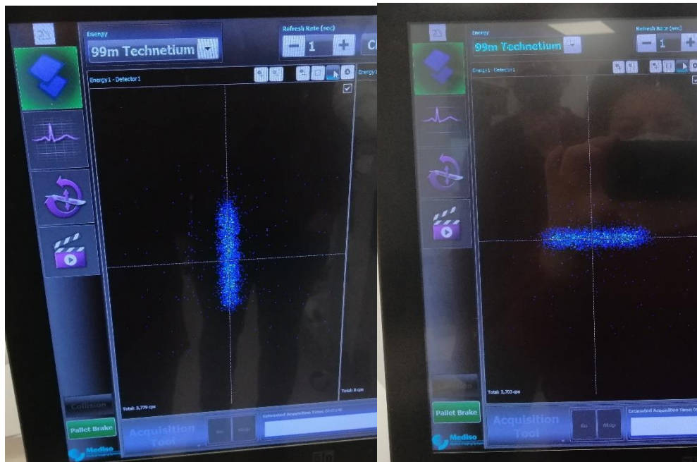
Εικόνα 32. Στιγμιότυπο από το Detector View. Επαλήθευση της σωστής τοποθέτησης της πηγής στον άξονα X (αριστερά) και στον άξονα Y (δεξιά).
