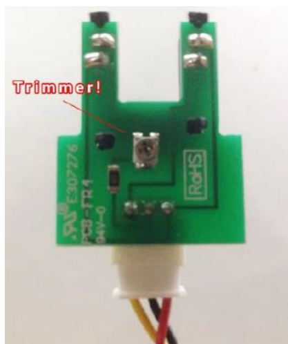
Εικόνα 21: Ποτενσιόμετρο εσωτερικά του αδιάβροχου περιβλήματος [12].
