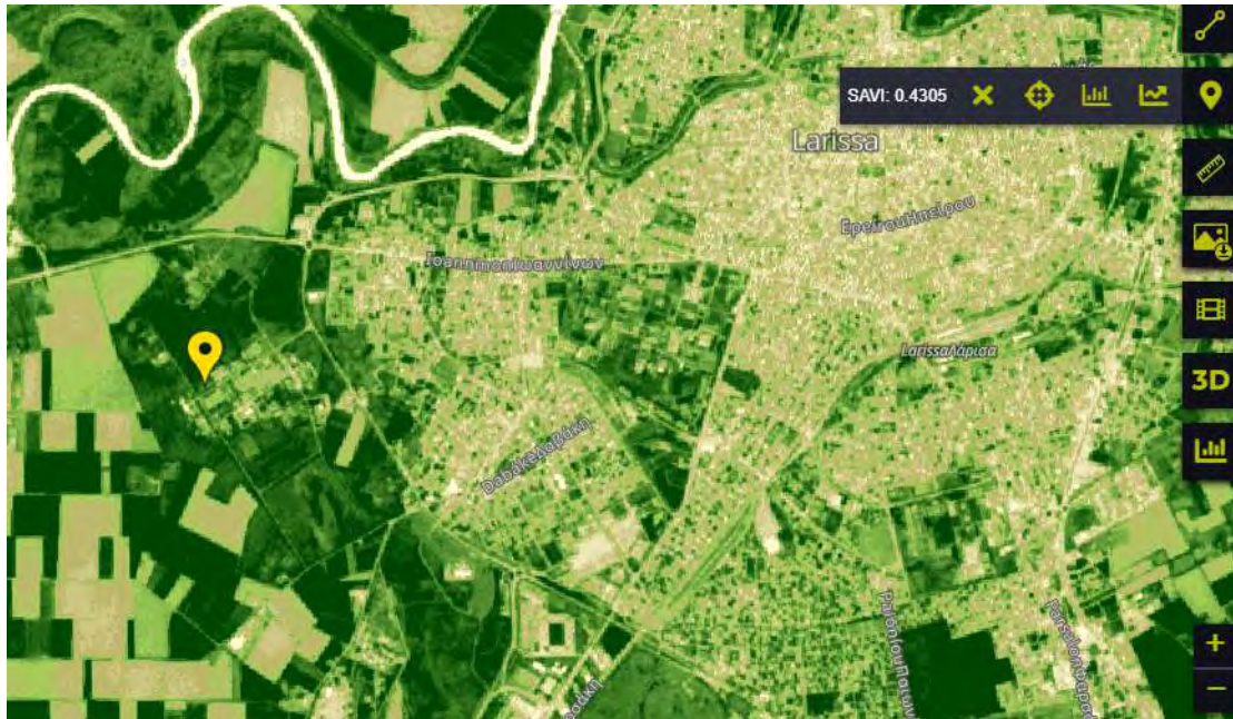
Εικόνα 19: Προσδιορισμός σημείου ενδιαφέροντος και μέτρηση δείκτη SAVI
