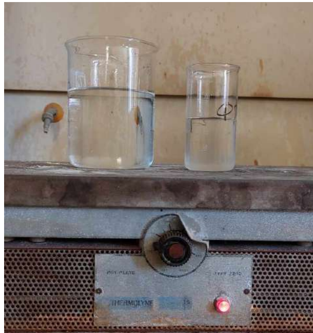
Εικόνα 30. Θέρμανση ποτηριού ζέσεως
