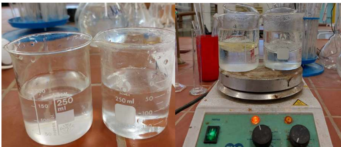
Εικόνα 33. Πλήρωση ποτηριών ζέσεως και τοποθέτησή τους στην εστία θέρμανσης
