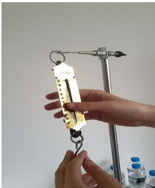
Εικόνα 39: Απτικό δυναμόμετρο αναρτημένο σε στήριξη βάσης
