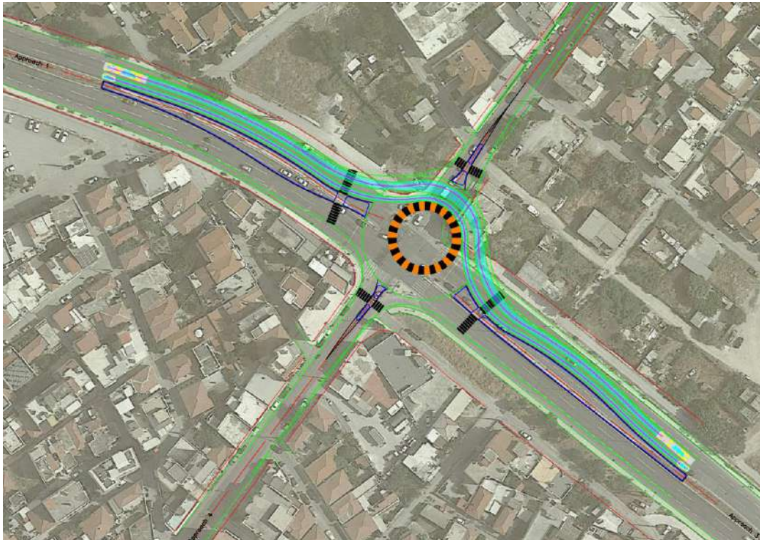
Εικόνα 3-4: Έλεγχος οπισθοτροχιάς παράλληλης κίνησης οχήματος σχεδιασμού και ΙΧ Πηγή: Ιδία επεξεργασία
