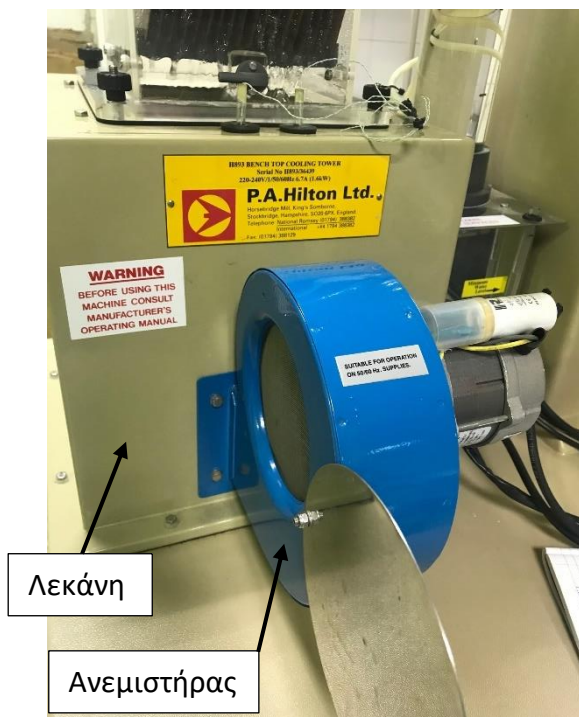
Εικόνα 3.4: Η λεκάνη, ο ανεμιστήρας και τα θερμοστοιχεία
