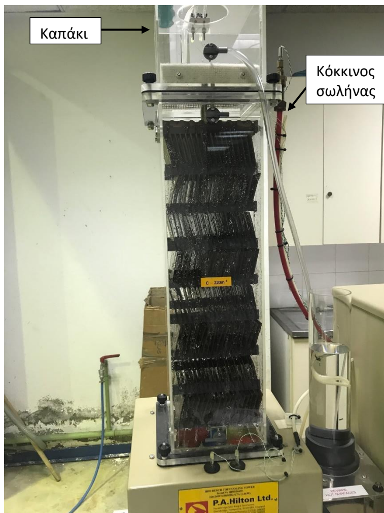
Εικόνα 3.2: Η στήλη με το πληρωτικό υλικό
