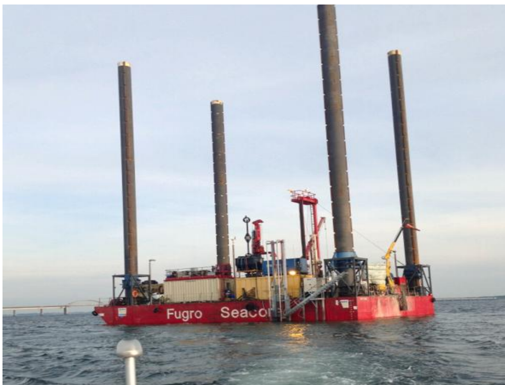
Εικόνα 4.2 Υπεράκτιο γεωτρύπανο εκτελεί έρευνες θαλάσσιου εδάφους (Πηγή: Olsen, et al. 2022).
