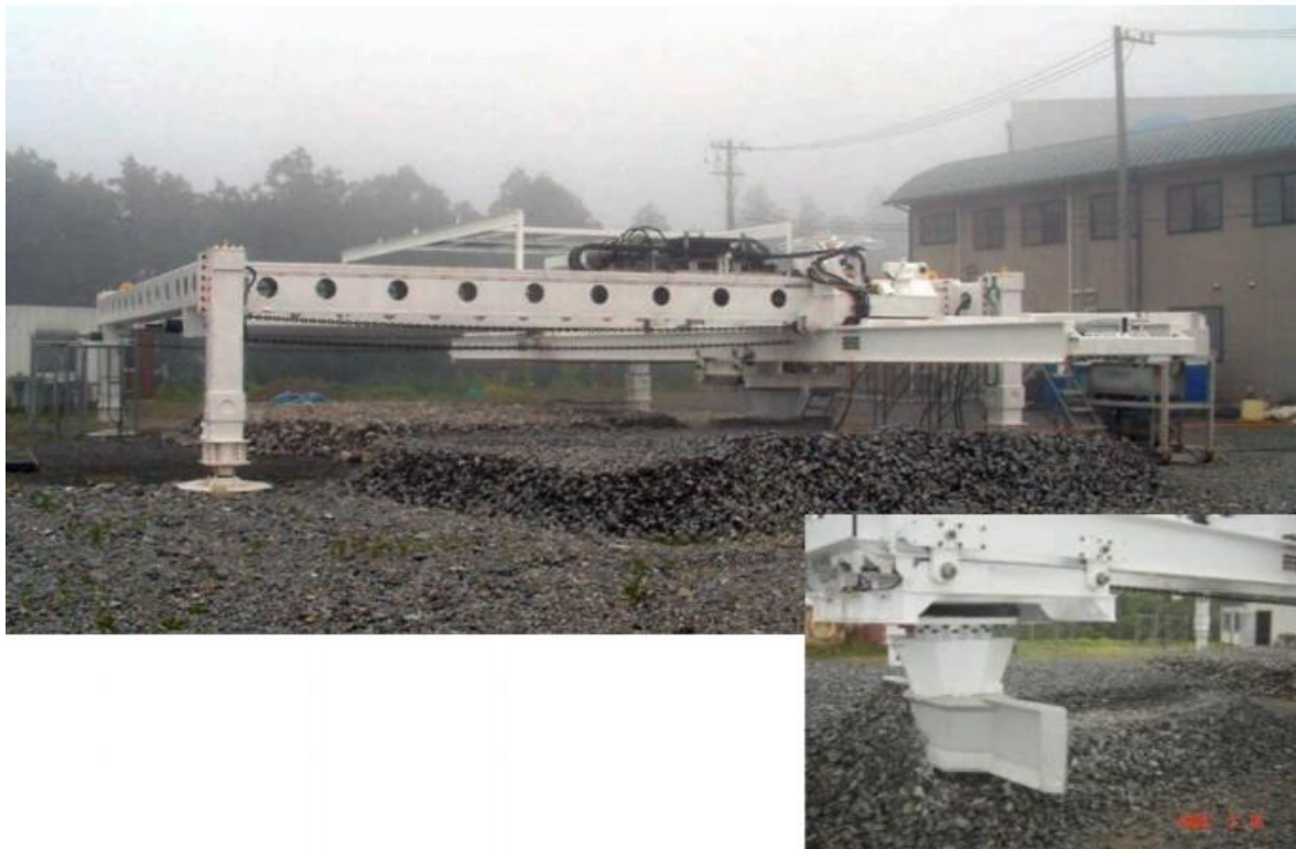
Εικόνα 4.19 Υποβρύχιο γκρέιντερ, δοκιμή (Πηγή: Olsen, et al. 2022).
