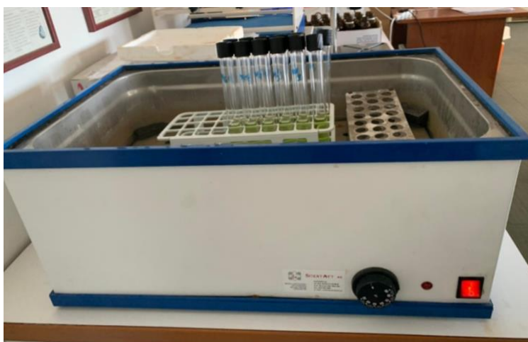
Εικόνα 2.4.1 : Υδατόλουτρο για τον αποχρωματισμό των ελασμάτων φύλλων
