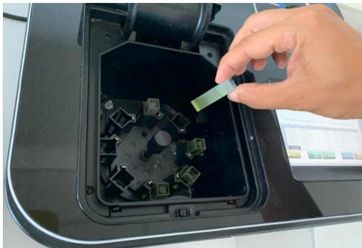
Εικόνα 2.4.2 Τοποθέτηση των κρυσταλλικών κυψελίδων στο φασματοφωτόμετρο
