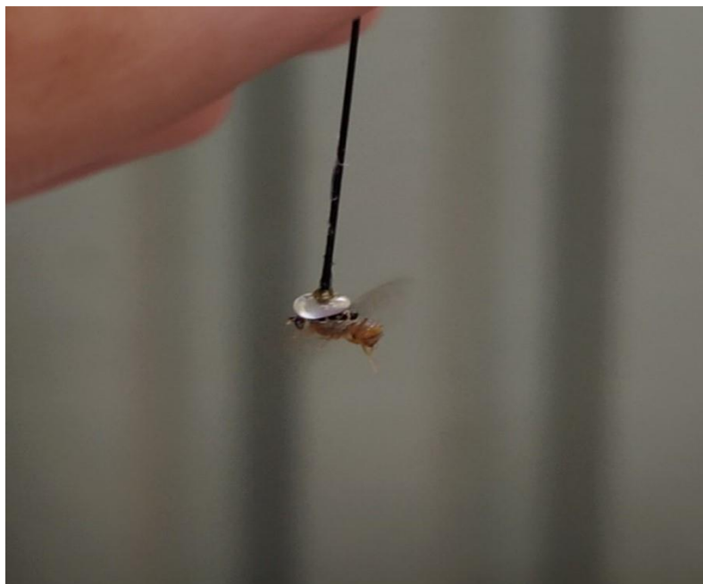
Εικόνα 2.9: Έντομο κολλημένο με θερμή κόλλα σιλικόνης
