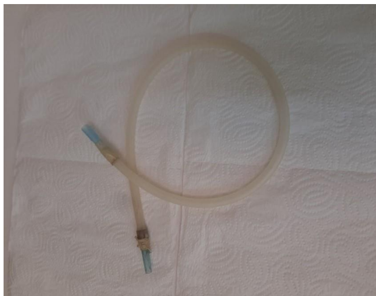
Εικόνα 2.5: Συσκευή αναρρόφησης εντόμων (aspirator)
