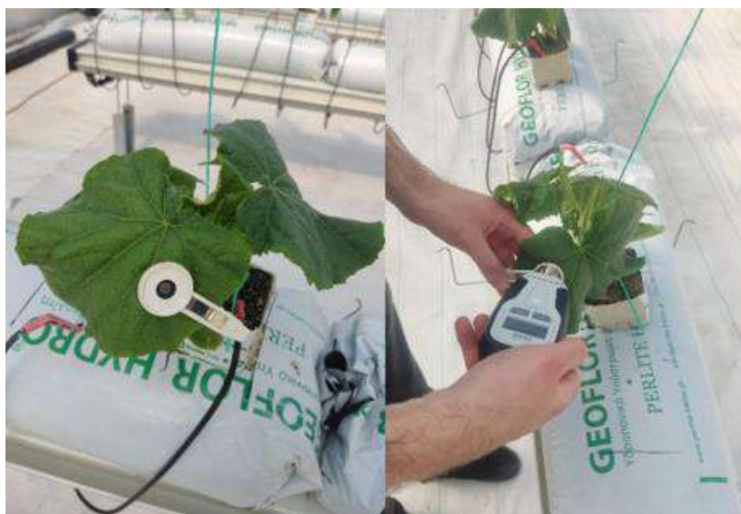
Εικόνα 5: Διαδικασία μέτρησης του φθορισμού της χλωροφύλλης a
