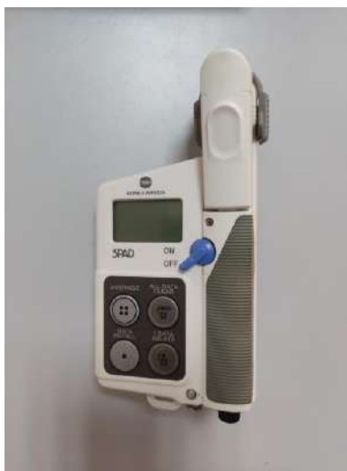
Εικόνα 4: Όργανο μέτρησης χλωροφύλλης.
