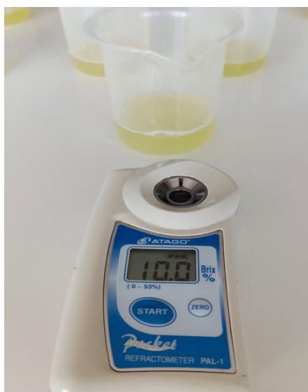
Εικόνα 18: Συσκευή μέτρησης ολικών διαλυτών στερεών, ρεφρακτόμετρο (PAL-1, ATAGO).
