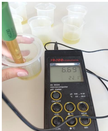
Εικόνα 17: Συσκευή μέτρησης pH, πεχάμετρο pH (HI 9024, HANNA instruments).
