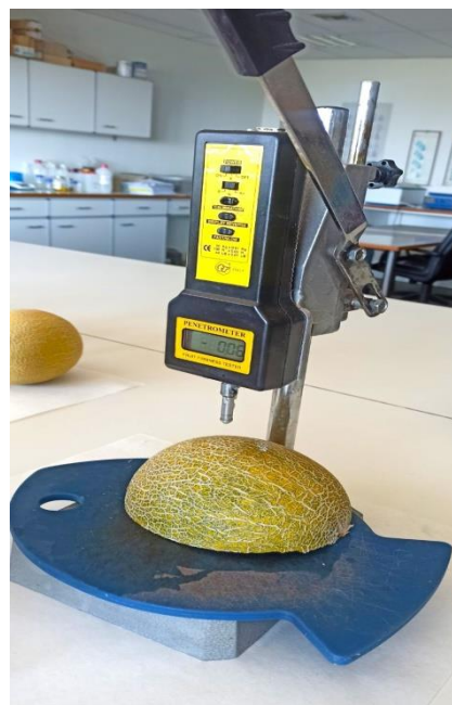
Εικόνα 16: Συσκευή μέτρησης σκληρότητας καρπού, πενετρόμετρο (Turon 53205).
