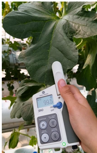
Εικόνα 10: Συσκευή μέτρησης συγκέντρωσης χλωροφύλλης SPAD-502 Plus, Konica Minolta
