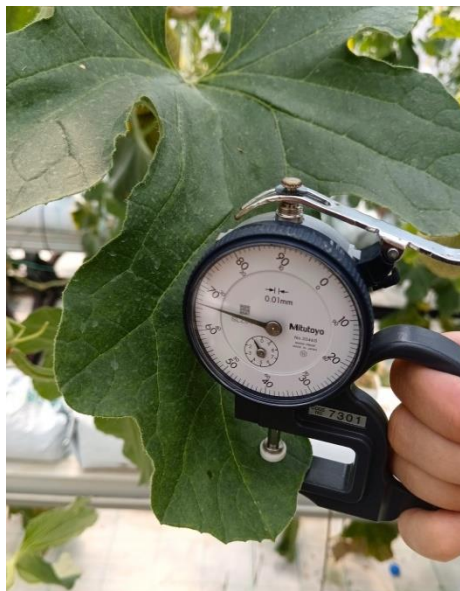
Εικόνα 12: Συσκευή μέτρησης του πάχους φύλλων (Mitutoyo)
