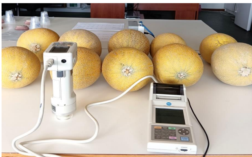
Εικόνα 17: Συσκευή μέτρησης χρώματος καρπού, χρωματόμετρο CR-400 της KONICA MINOLTA OPTICS INC.
