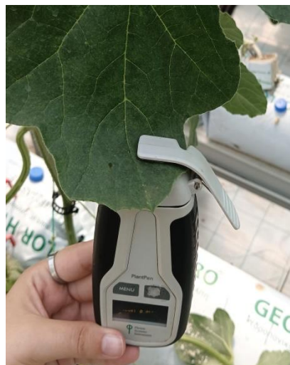
Εικόνα 11: Συσκευή μέτρησης του δείκτη φωτοχημικής ανάκλασης PRI
