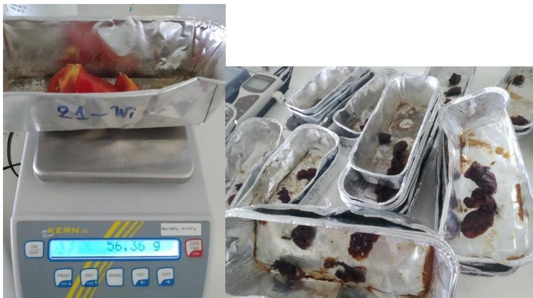
Εικόνες 25 και 26. Μέτρηση νωπού βάρους δείγματος και αποξηραμένα δείγματα μετά την παραμονή τους στον κλίβανο (προσωπικό αρχείο, 2022)
