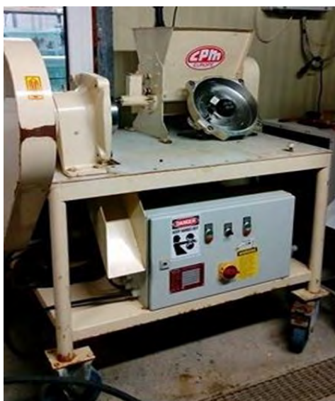
Εικόνα 2.5. Πελλετομηχανή τύπου California Pellet Mill
