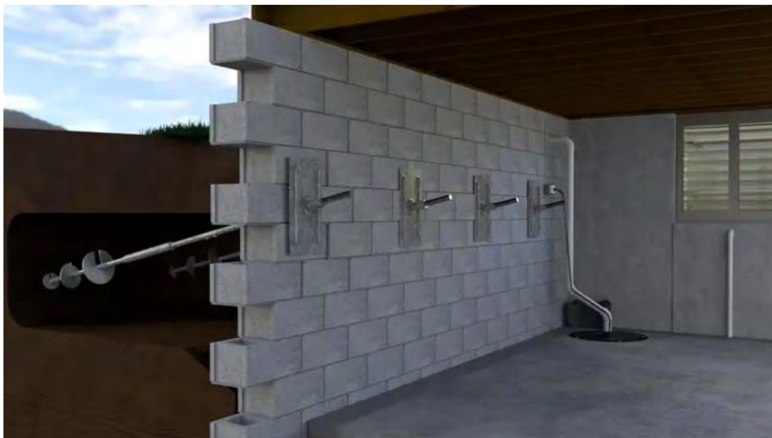
Εικόνα 40. Τοίχος αντιστήριξης με ελικοειδείς άγκυρες
