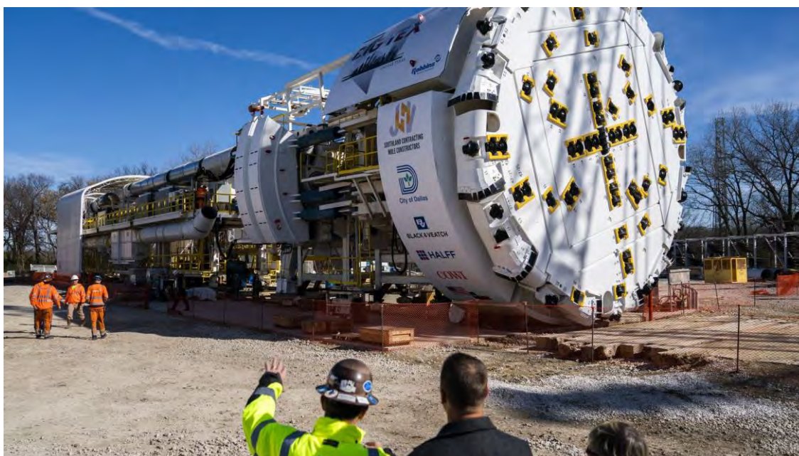
Εικόνα 14. Μηχάνημα για το άνοιγμα μεγάλης σήραγγας στο Ντάλας στις ΗΠΑ (Anon., 2023).
