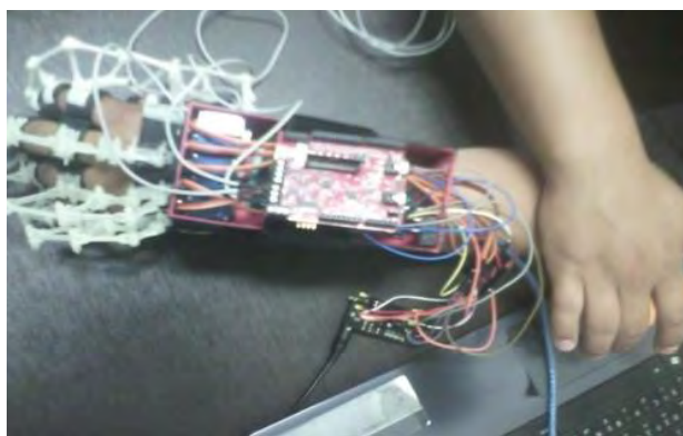
Εικόνα 14: Μηχανοτρονικός σχεδιασμός: Εξαρτήματα μονάδων ελέγχου.
