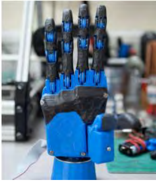
γ) Ο συμπαγής σχεδιασμός του Open Hand Project που χρησιμοποιεί DC Κινητήρες
