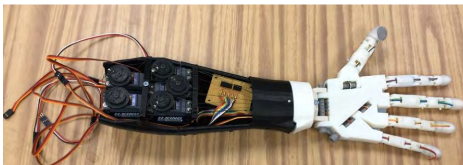
Εικόνα 29: Άνω όψη του συναρμολογημένου χεριού με τον αντιβραχίονα ανοιχτό, όπου φαίνονται τα σερβομηχανήματα στο εσωτερικό του.
