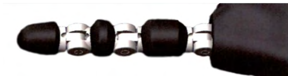
Εικόνα 23: Σχέδιο του χεριού της ομάδας του Pizarro, που δείχνει το δέρμα (μαύρο) και την εκτεθειμένη δομή των οστών (λευκό).
