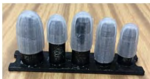
α) 3D εκτυπωμένο καλούπι για τις άκρες των δακτύλων σιλικόνης, με δάχτυλο με άκρες στην θέση τους.
