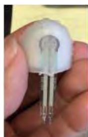
β) Τρισδιάστατο εκτυπωμένο άκρο δακτύλου αντίχειρα, εφοδιασμένο με άκρο δακτύλου σιλικόνης που περικλείει τον αισθητήρα δύναμης.
