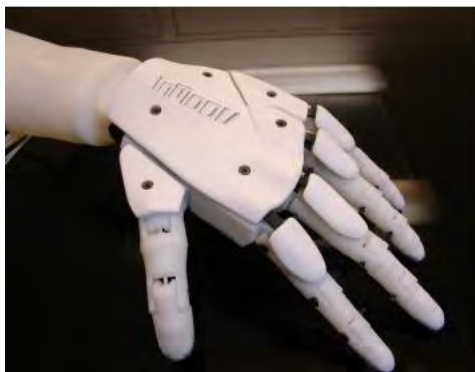
δ) Συναρμολογημένο χέρι του 3D εκτυπώσιμου ανθρωποειδούς της InMoov Ρομπωτικό έργο
