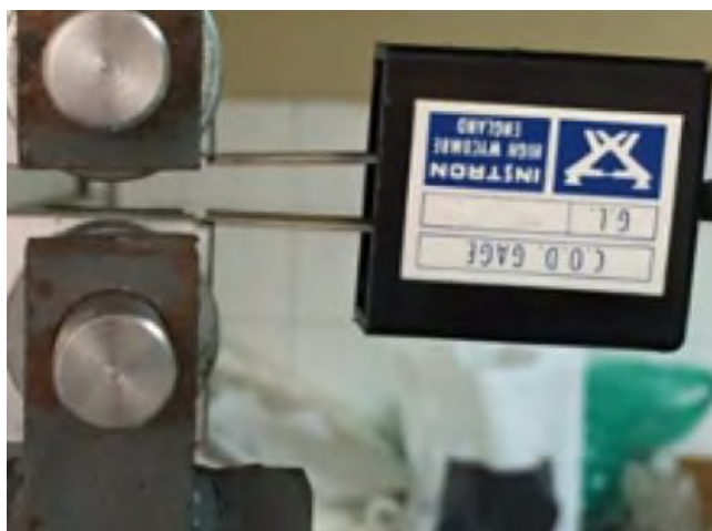
Εικόνα 4.4: Τοποθέτηση επιμηκυνσιόμετρο για την καταγραφή παραμόρφωσης v_{\max} .
