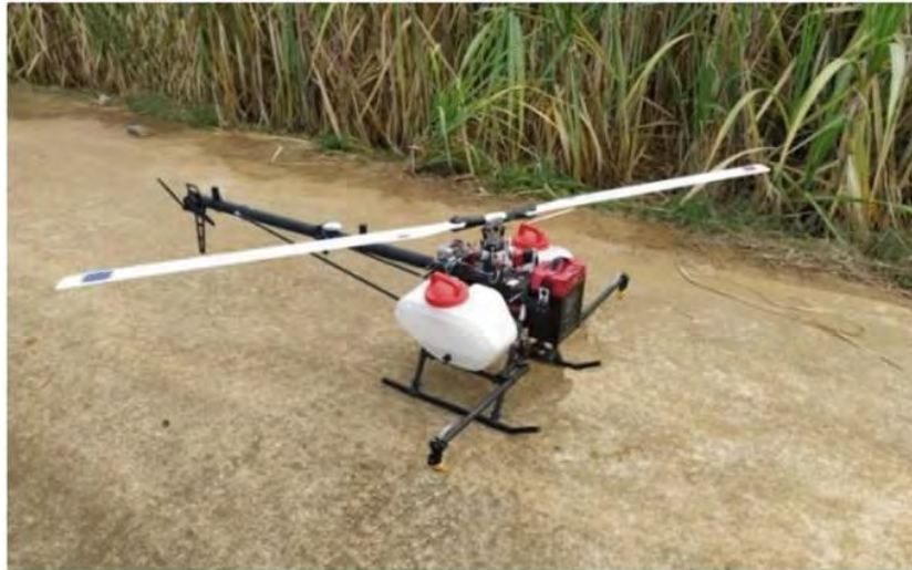
Εικόνα 8 UAV μονού ρότορα για ψεκασμό σε καλλιέργειες [53].
