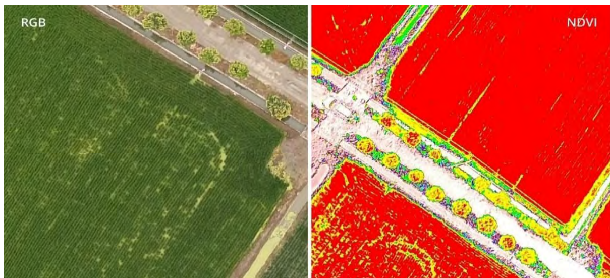
Εικόνα 1 Λήψη φωτογραφίας από πολυφασματική κάμερα 1 Αριστερά: εικόνα με χρώματα κόκκινο, πράσινο, μπλε. Δεξιά: εικόνα με δείκτη ευρωστίας NDVI.
