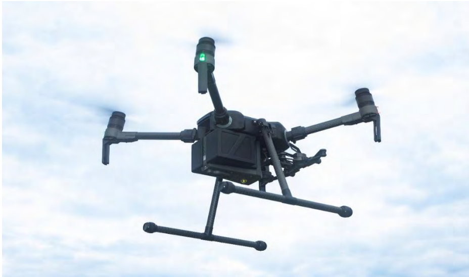
Εικόνα 6 Drone με πολλαπλούς ρότορες (DJI Matrice 210).
