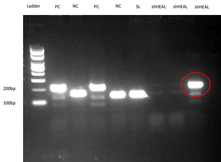
Εικόνα 22: Ηλεκτροφόρηση των προϊόντων διαγνωστικής PCR του φορέα pSicoR με σκοπό την ανίχνευση θετικών φορέων για το shHEAL σε πηκτή αγαρόζης 2%. Ladder : μάρτυρας μοριακών βαρών 100bp της Enzyquest . NC : αρνητικό δείγμα ελέγχου. PC : θετικό δείγμα ελέγχου. SL : self ligation
