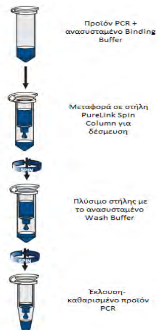
Εικόνα 29 Σχηματική απεικόνιση της μεθόδου καθαρισμού προϊόντων PCR.
