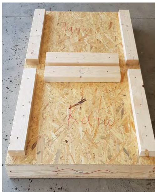
Εικ. 54 Τελική όψη των κλειδιών στο πάνω και κάτω μέρος
