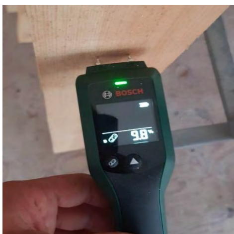
Εικ. 44 Τέταρτη μέτρηση υγρασίας μετά από 40 μέρες
