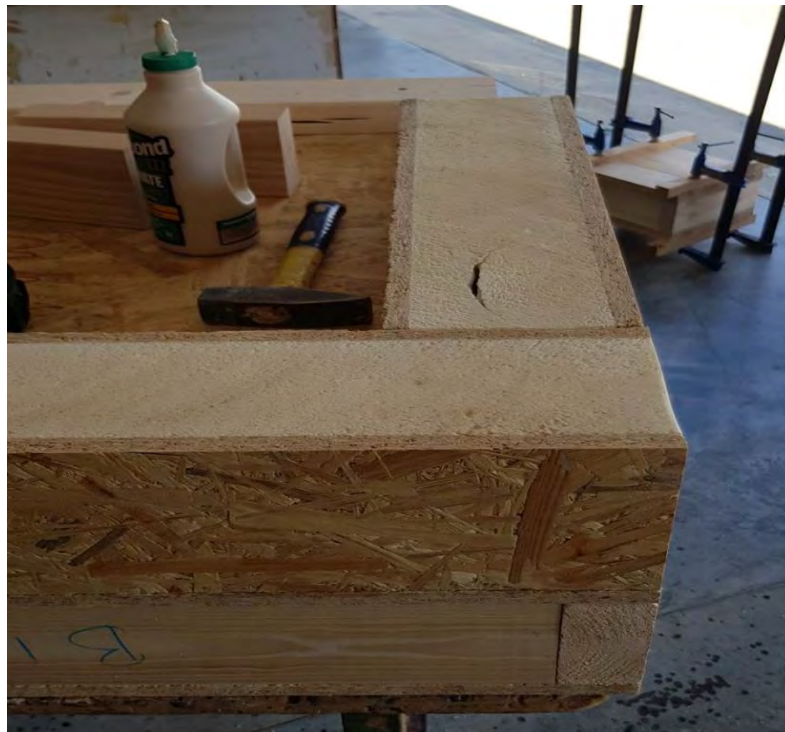
Εικ. 53 Ακριβής εφαρμογή των κλειδιών με βοηθητικά πάνελ
