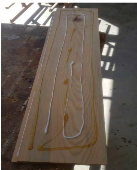
Εικ. 85 Εφαρμογή των κολλών στη επιφάνεια του ξύλου
