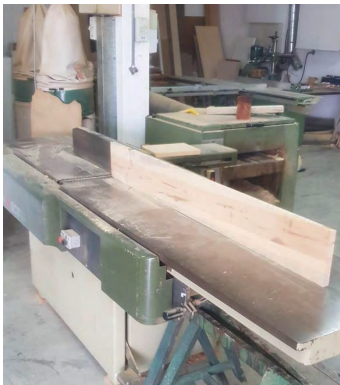
Εικ. 58 Πλάνισμα τεμαχίων στην πλάνια
