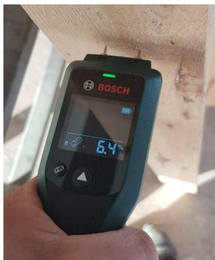
Εικ. 45 Τελευταία μέτρηση υγρασίας μετά από 3 μήνες
