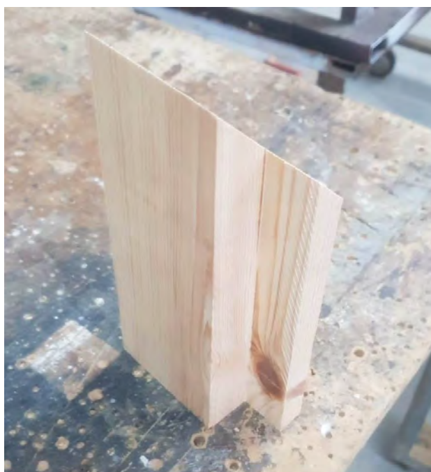
Εικ. 73 Όψη πατούρας για την εφαρμογή του γυαλιού
