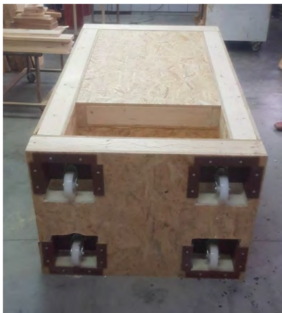
Εικ. 84 Τοποθέτηση τροχών μετακίνησης της κάβας
