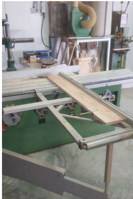
Εικ. 62 Κοπή τεμαχίων στις τελικές τους διαστάσεις στον επιτραπέζιο δίσκο κοπής
