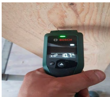
Εικ. 43 Τρίτη μέτρηση υγρασίας μετά από 1 μήνα.
