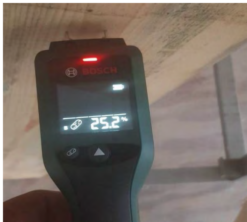
Εικ. 41 Πρώτη μέτρηση υγρασίας
