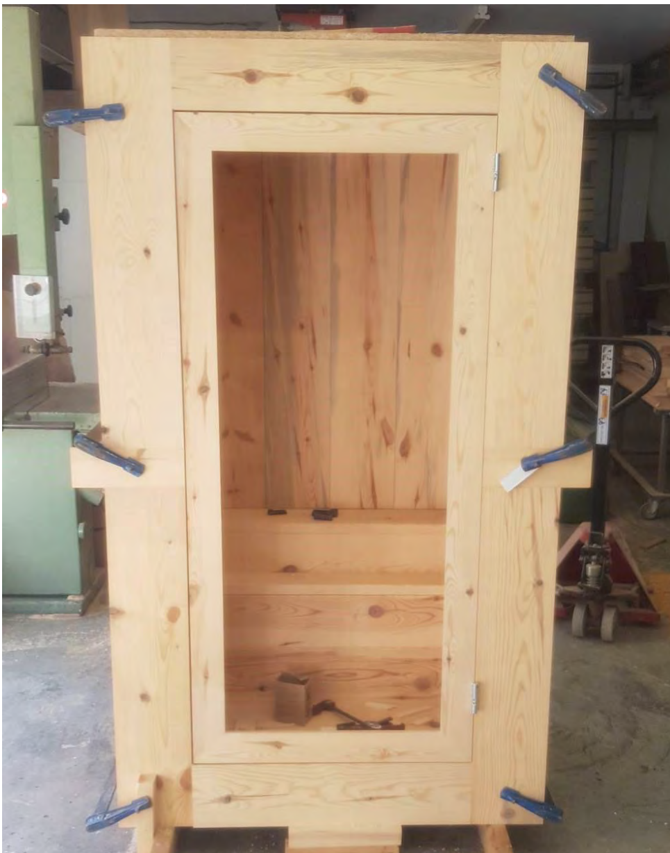
Εικ. 79 Εφαρμογή πόρτας και έλεγχος μεντεσέδων
