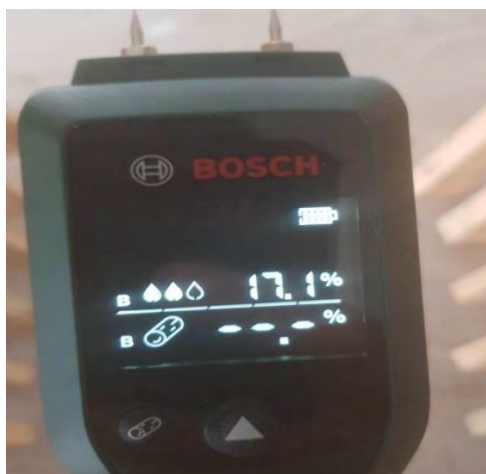
Εικ. 42 Δεύτερη μέτρηση υγρασίας μετά από 2 εβδομάδες
