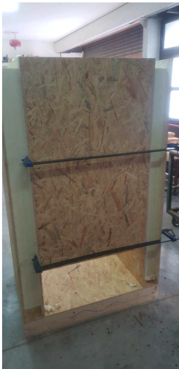
Εικ. 67 Τοποθέτηση δεξιού τοιχώματος και συγκόλληση με τα άλλα τοιχώματα
