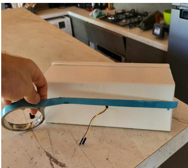
Εικόνα31: Τοποθέτηση ταινίας Double Face, για συγκόλληση κατασκευής με θύρας
