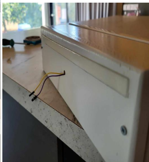
Εικόνα31: Τοποθέτηση ταινίας Double Face, για συγκόλληση κατασκευής με θύρας
