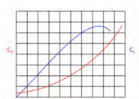
Σχήμα 4.2: Σχέση αεροδυναμικών συντελεστών με την γωνία προσβολής.
