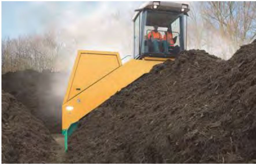
Εικόνα 3.7. Κομποστοποίηση ανοιχτού τύπου, με ανάδευση.
