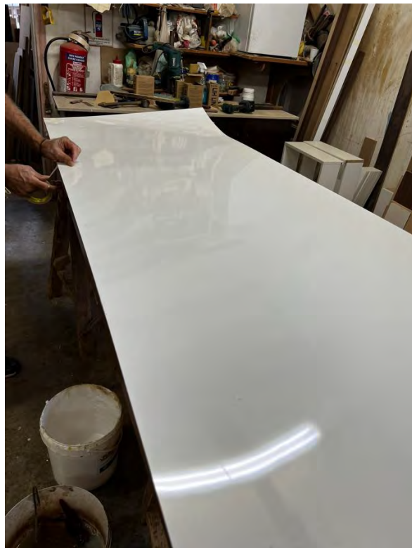
Εικόνα 25: Επικάλυψη πόρτας με φορμάικα
