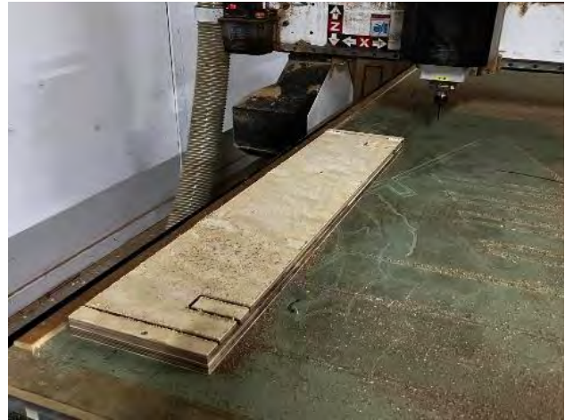
Εικόνες 21: Από την διαδικασία χάραξης από το μηχανήματος CNC
