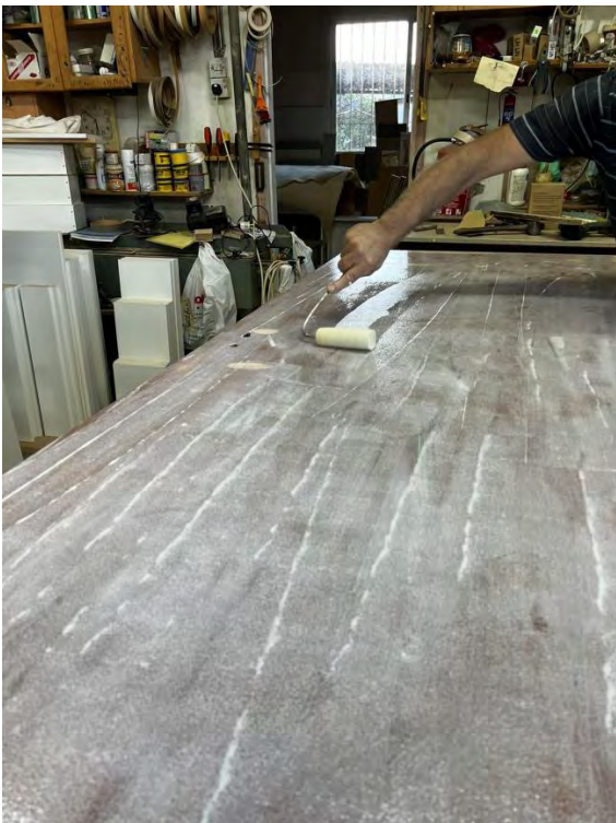
Εικόνα 24: Επικάλυψη πόρτας με υδατοδιαλυτή λευκή κόλλα ξύλων, βάσεως PVAC
