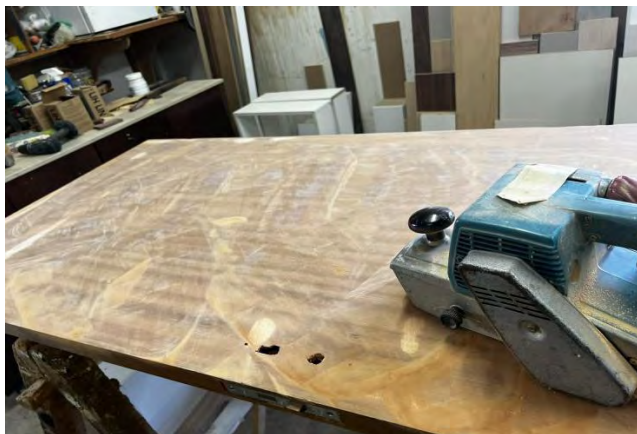
Εικόνα 22: Τρίψιμο πόρτας με τριβείο
