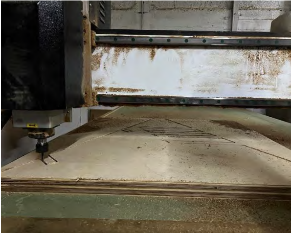
Εικόνες 21: Από την διαδικασία χάραξης από το μηχανήματος CNC
