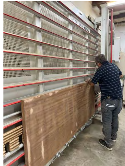
Εικόνα 23: Κόψιμο πόρτας σε Δίσκο κοπής
