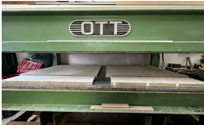
Εικόνα 20: Διαδικασία πρεσαρίσματος κομματιών κόντρα πλακέ
