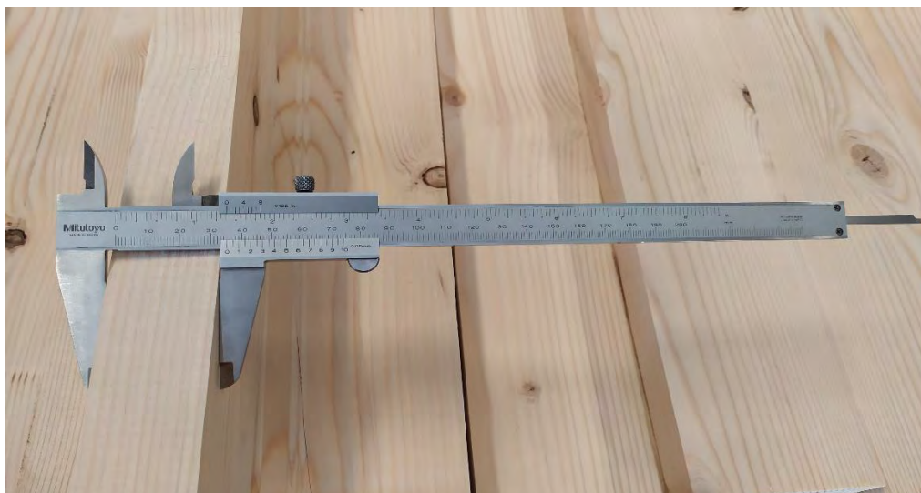
Εικόνα 72 Μέτρηση πάχους ξυλείας με ειδικό παχύμετρο
