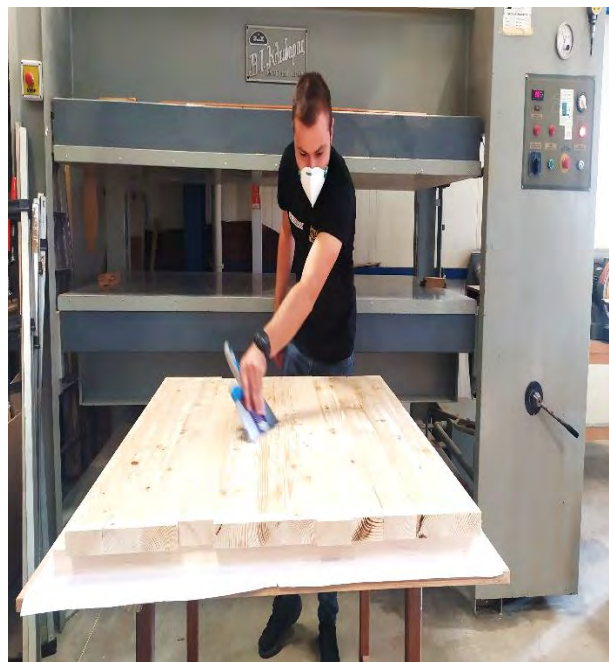
Εικόνα 78 Επάλειψη συγκολλητικής ουσίας
