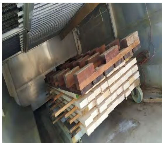
Εικόνα 64 Εσωτερική όψη ξηραντηρίου με τοποθετημένα τα προς ξήρανση δοκίμια
