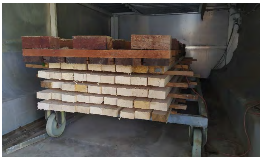
Εικόνα 68 Οπτικός έλεγχος προόδου ξήρανσης
