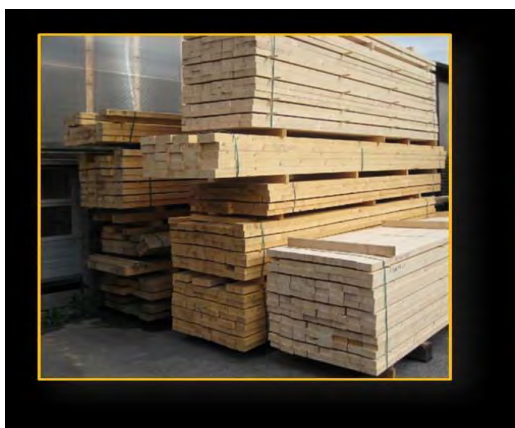
Εικόνα 30 Τοποθέτηση σε στοίβες
