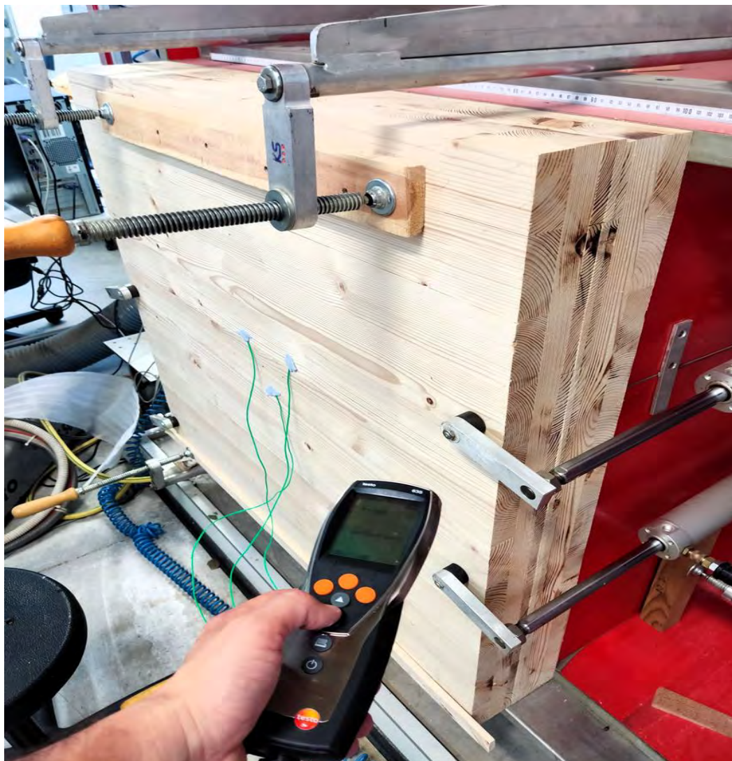
Εικόνα 88 Διαδικασία μέτρησης θερμοπερατότητας στο 5στρωμο πάνελ
