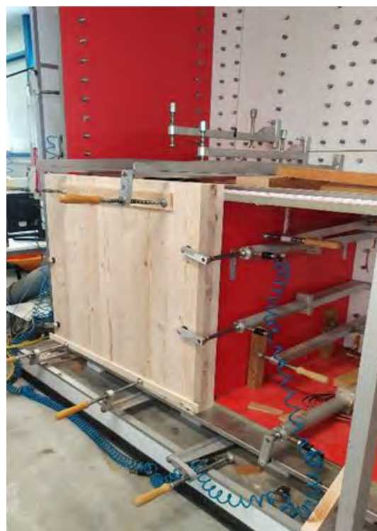
Εικόνα 84 3στρωμο πάνελ τοποθετημένο στο μηχάνημα μετρήσεων θερμοπερατότητας
