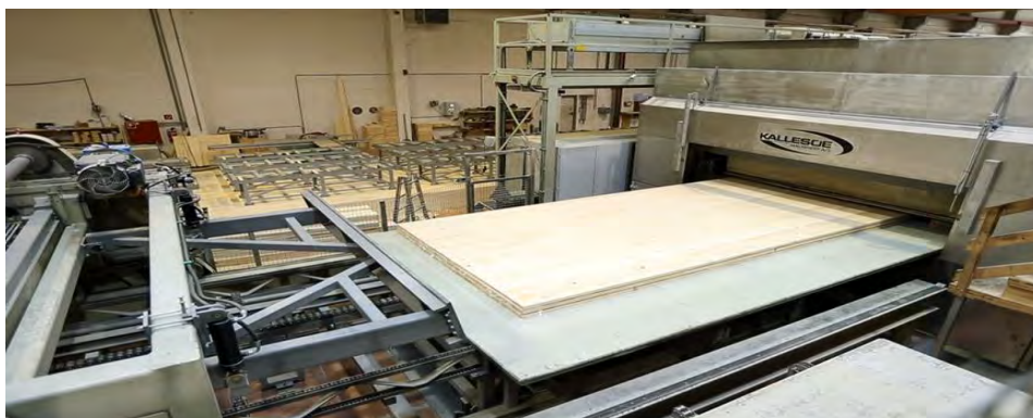
Εικόνα 35 Εισαγωγή πάνελ στην ειδική πρέσα
