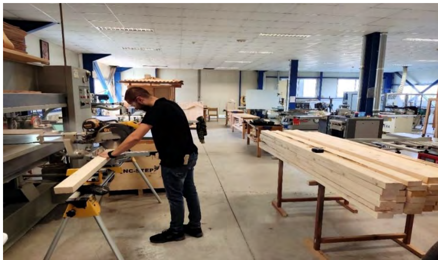
Εικόνα 70 Τεμαχισμός ξυλείας σε επιτραπέζιο δισκοπρίονο τύπου ράντιαλ
