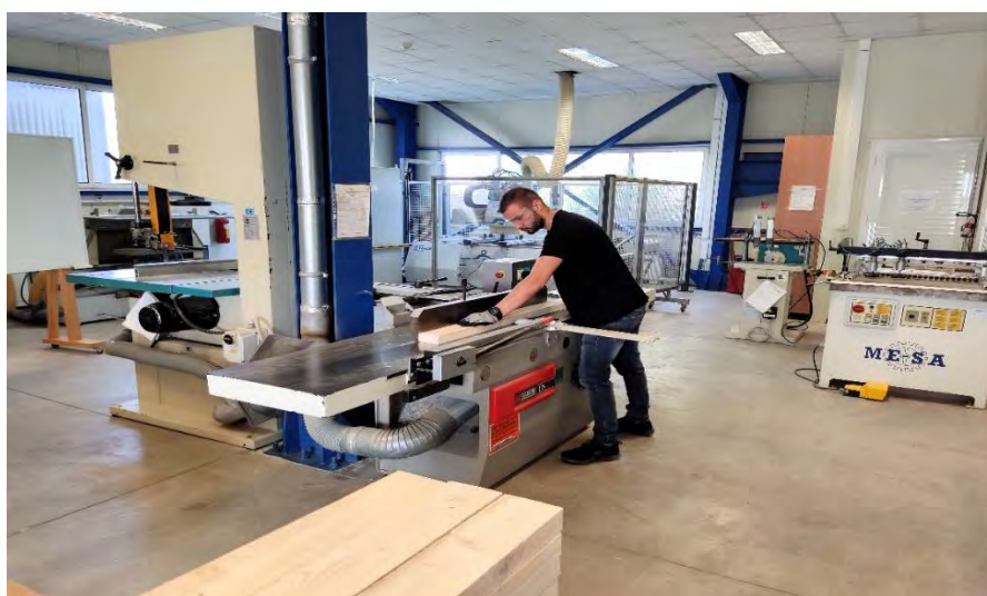
Εικόνα 71 Κατεργασία λειάνσεως ξυλείας (πλάνισμα)
