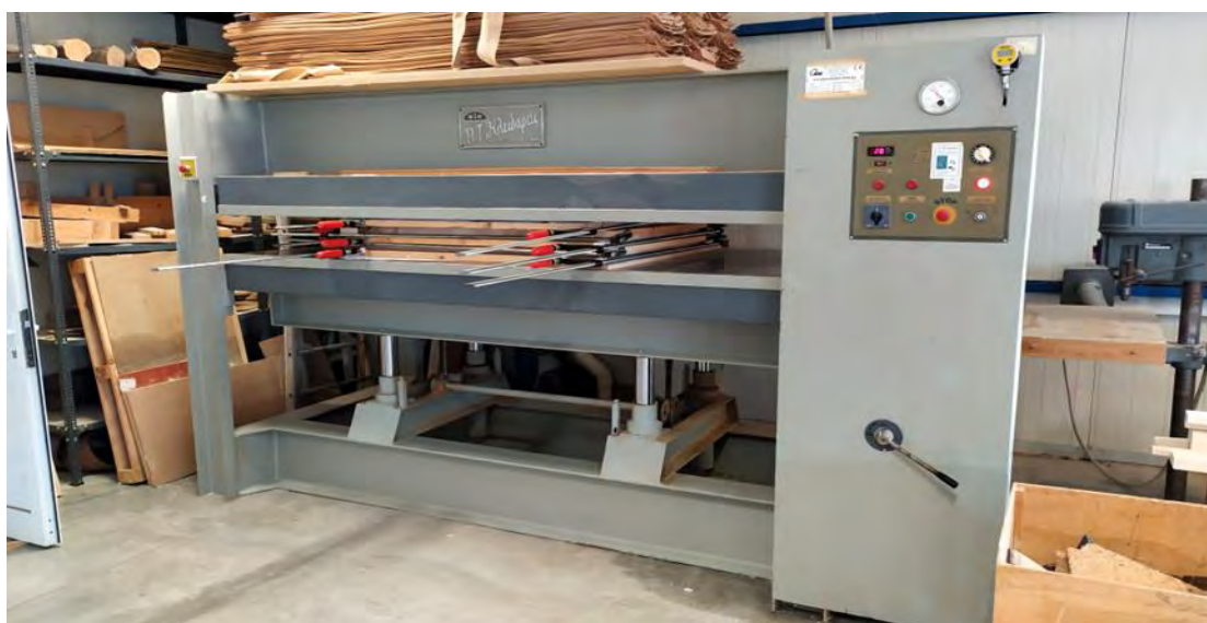
Εικόνα 85 Τοποθέτηση 5στρωμου πάνελ στην θερμαινόμενη πρέσα
