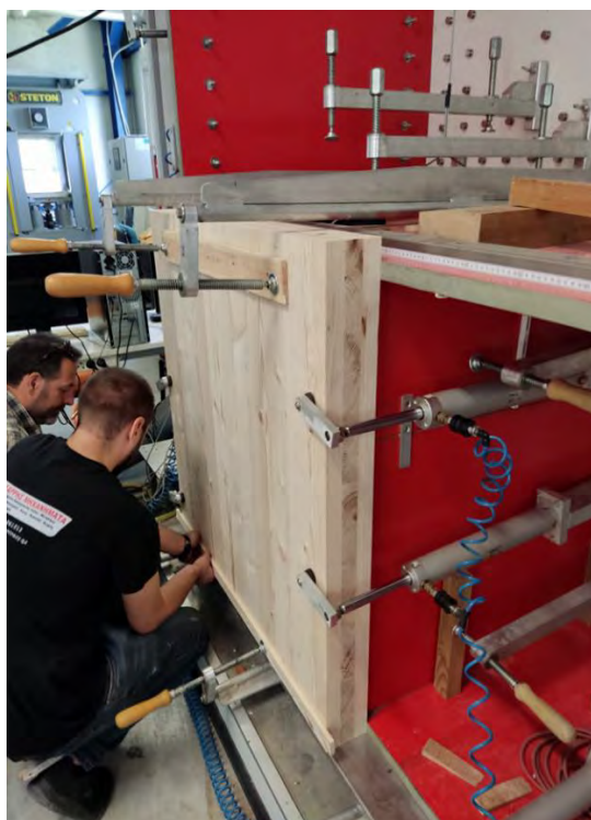
Εικόνα 83 Τοποθέτηση 3στρωμου πάνελ στο μηχάνημα μετρήσεων θερμοπερατότητας
