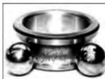
Εικόνα 3.7-7: Κατεστραμμένο ρουλεμάν στο τελικό στάδιο φθοράς
