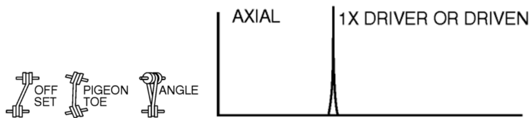
Εικόνα 3.9-2: Αριστερά βλέπουμε περιπτώσεις ανευθυγραμμίας ιμάντων - τροχαλιών και δεξιά τυπικό διάγραμμα FFT για ανευθυγραμμία ιμάντα τροχαλίας
