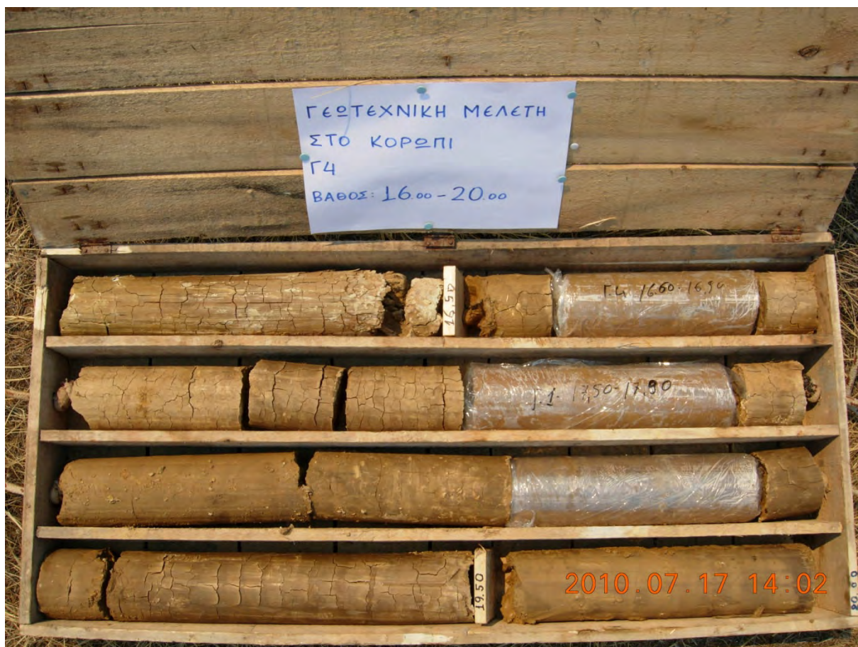
Εικόνα 11: Δείγματα γεώτρησης Γ4 (βάθους 16-20 μέτρων)
