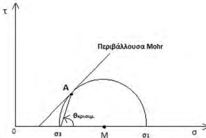
Σχήμα 7. Κύκλος του Mohr
