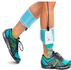
Εικόνα 10 Τοποθέτηση cuffs του F-Scan στο πόδι (Tekscan Inc, 2023)
