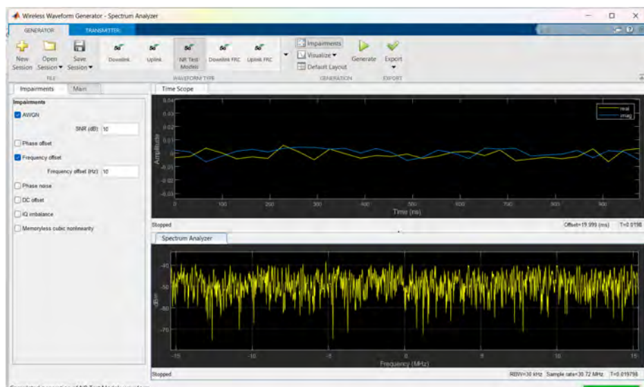
Εικόνα 28 5G New Radio (NR) με μοντέλο καναλιού NR FR1 TM1.1 (Uniform, QPSK) με SNR=10 dB
