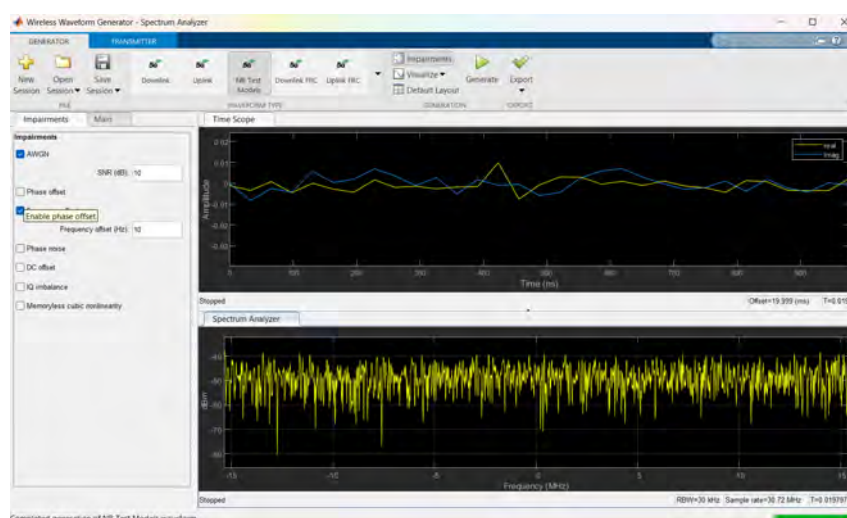
Εικόνα 30 5G New Radio (NR) με μοντέλο καναλιού NR FR1 TM3.1 (Uniform, 64-QAM) με SNR=10 dB
