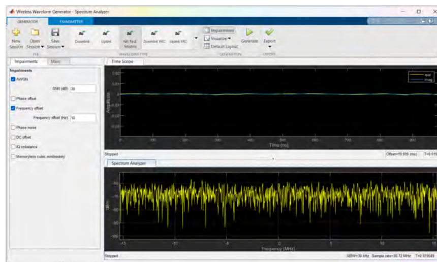
Εικόνα 32 5G New Radio (NR) με μοντέλο καναλιού NR FR1 TM3.1 (Uniform, 64-QAM) με SNR=30 dB
