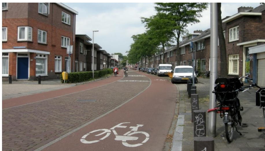
Εικόνα 28:παράλληλη και contraflow λωρίδα ποδηλατοδρόμου μονής κίνησης σε κεντρική οδό μονής κατεύθυνσης στην Ουτρέχτη (πηγή: Wikipedia)
