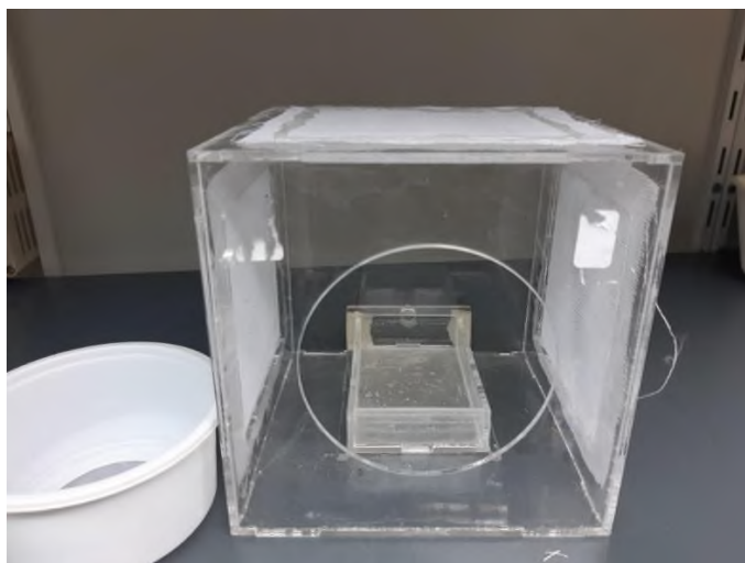
Εικόνα 2.5 Plexi glass κλωβός ωτοκίας κουνουπιών του γένους Culex
