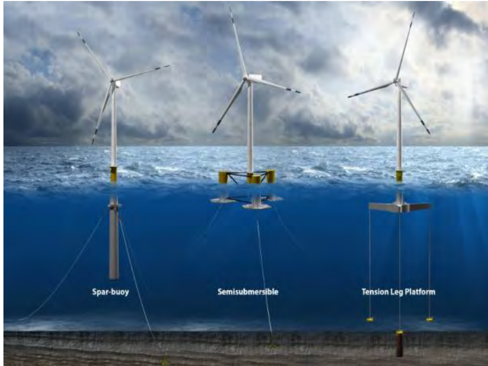
Εικόνα 3.28: 3 κατηγορίες πλωτών κατασκευών, (Wind Energy Technologies Office, 2017)
