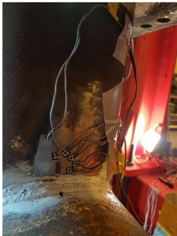
Εικ. 3.9 Χρήση strain gauges στα Crown Points[1]
