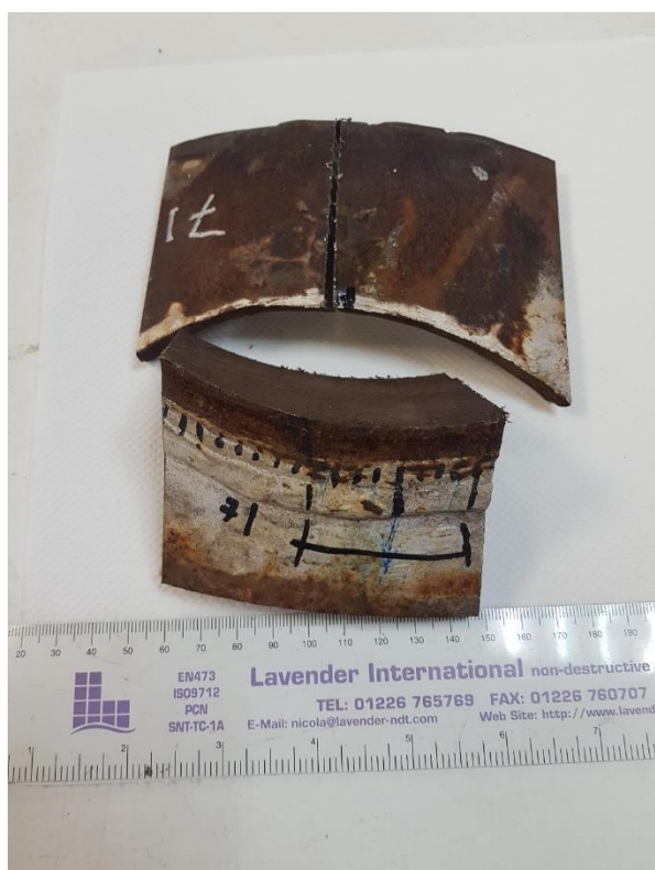
Εικ. 4.15 X6 πλευρά 1 σημείο κοπής για μεταλλογραφία
