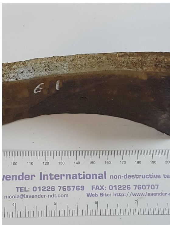
Εικ. 3.10-3.11 Επιφάνεια Θραύσης του δείγματος Χ6 πλευρά 1
