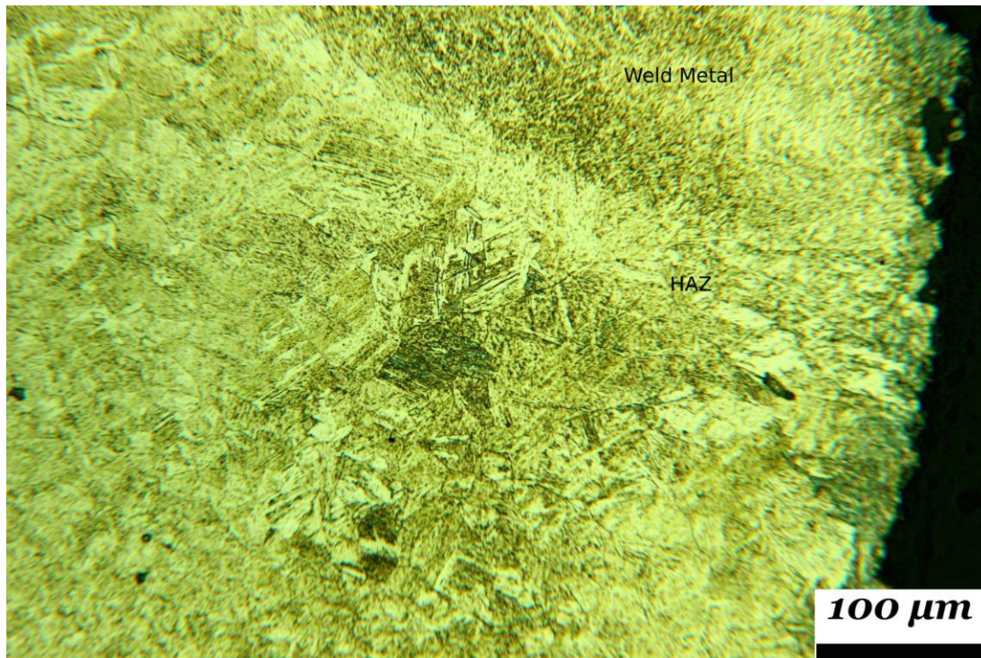
Εικ. 4.26 Δείγμα Χ7 Εστίαση στην ΘΕΖ στο chord
