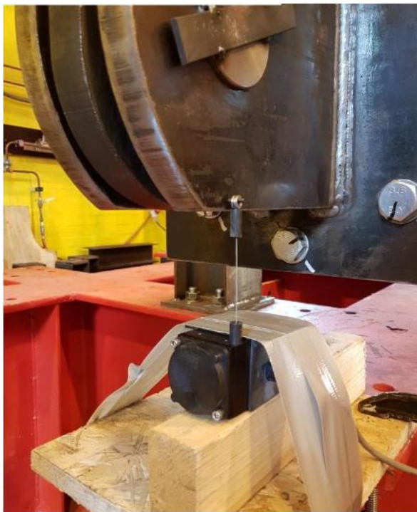
Εικ. 3.8 Χρήση ποτενσιόμετρων στα edges[1]
