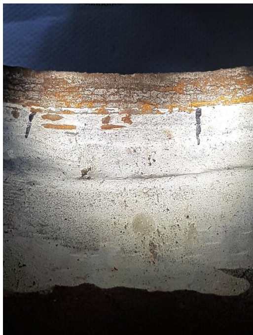
Εικ. 4.8 Τόξο κόπωσης δείγμα X5
