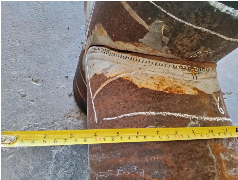
Εικ. 3.10 Αστοχία στο Δείγμα X6
