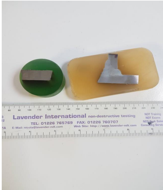
Εικ. 4.20 Εγκιβωτισμένα δοκίμια Χ6 πλευρά 1
