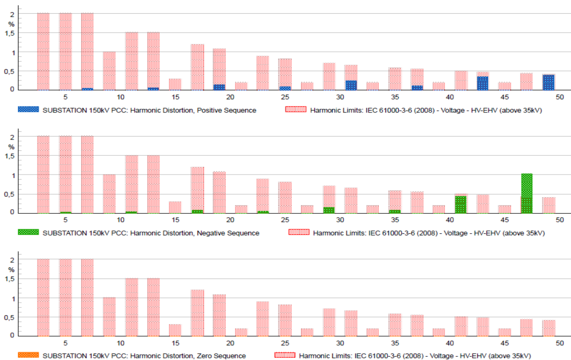
Διάγραμμα 2. Μη ισορροπημένη συνολική αρμονική παραμόρφωση στο σημείο κοινής σύζευξης χωρίς φίλτρο.
