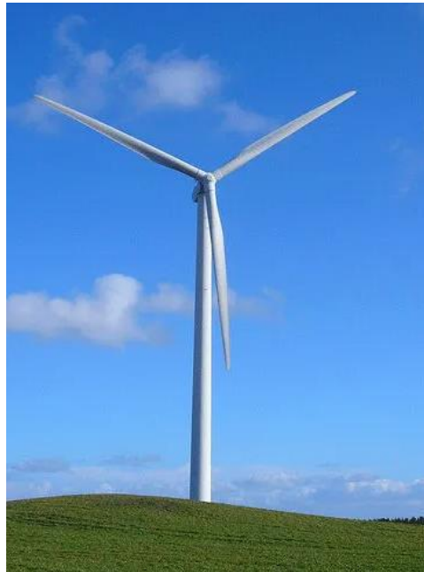
Εικόνα 5.6: Ανεμογεννήτρια οριζόντιου άξονα
