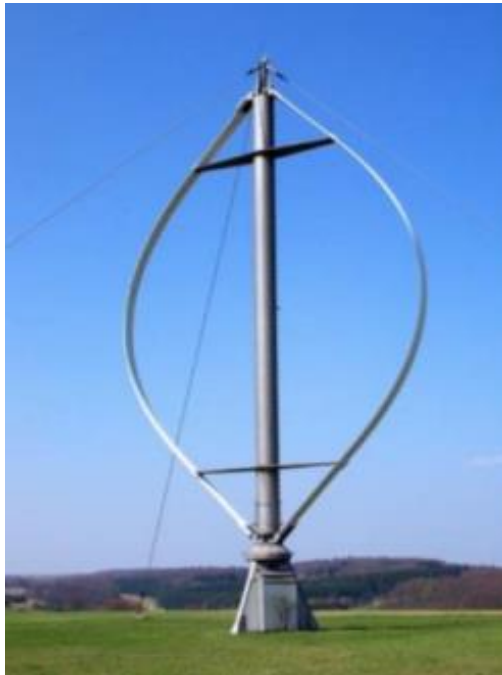
Εικόνα 5.8: Ανεμογεννήτρια κατακόρυφου άξονα
