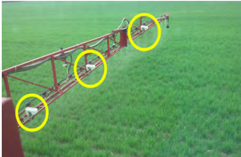
Σχήμα 4.1: Τοποθετημένοι πολλαπλοί σημειακοί αισθητήρες σε ψεκαστικό αγροτικό μηχάνημα
