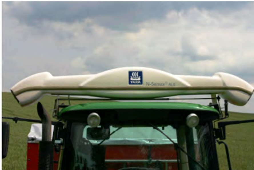
Σχήμα 3.1: Παθητικός αισθητήρας, ο αισθητήρας NSensor της Yara [5]
