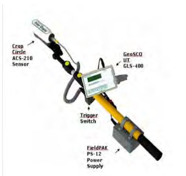
Σχήμα 3.2: Αισθητήρας Crop Circle [6]
