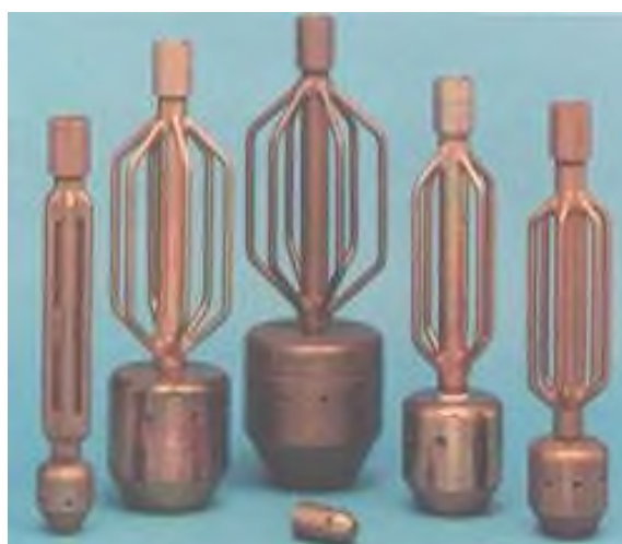
Σχήμα 5.27: Συσκευές “jetting” καθαρισμού γεωτρήσεων [186]
