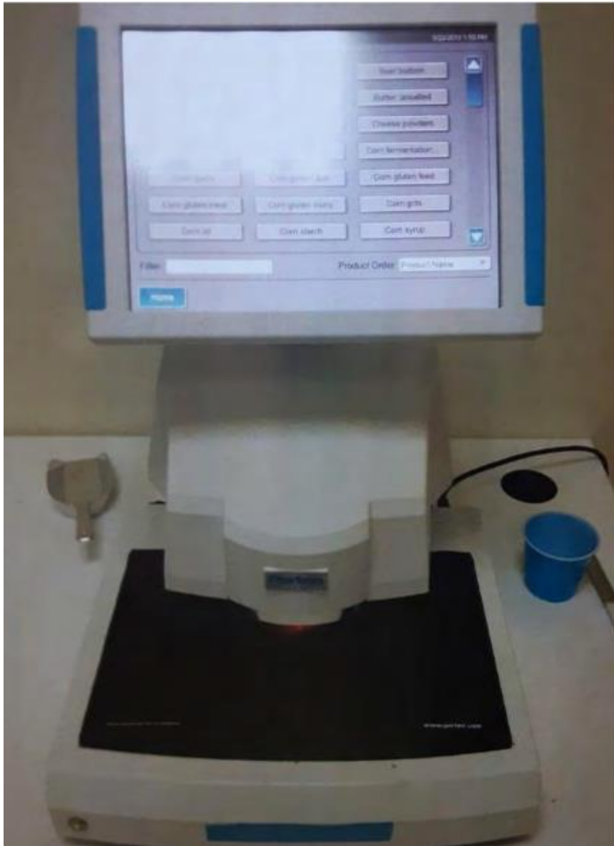
Εικόνα 2.3: Το Φασματοφωτόμετρο (NIR) του εργαστήριου Γεωργίας και Εφαρμοσμένης Φυσιολογίας Φυτών που πραγματοποιήθηκαν οι αναλύσεις.
