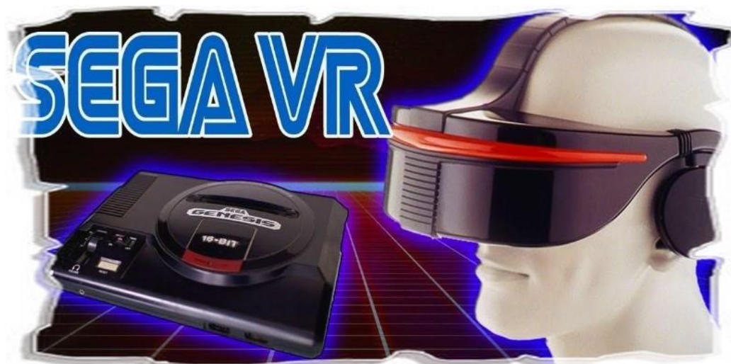
Εικόνα 2.9: Sega VR. Φορητή συσκευή εικονικής πραγματικότητας. Εκτός από τις οθόνες προβολής και τα ακουστικά, η συσκευή διαθέτε και ανιχνευτές κίνησης της κεφαλής. Sega, 1993.
