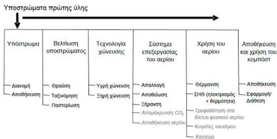
Εικόνα 25:Κύρια θήματα διεργασίας παραγωγής βιοαερίου (57)
