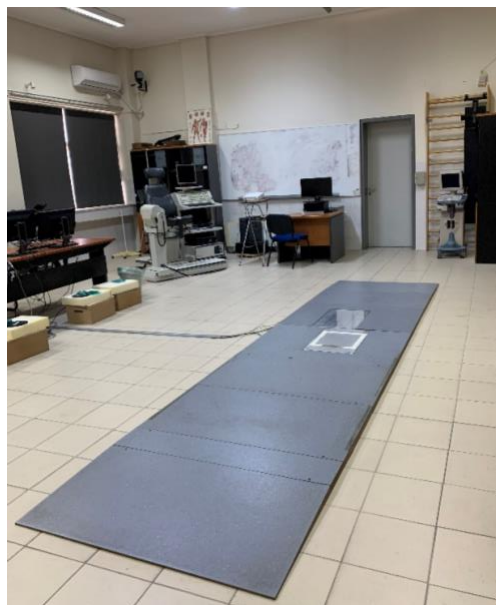
Εικόνα 4.3: Δυναμοδάπεδο Kistler που χρησιμοποιήθηκε για την αξιολόγηση της εγκυρότητας
