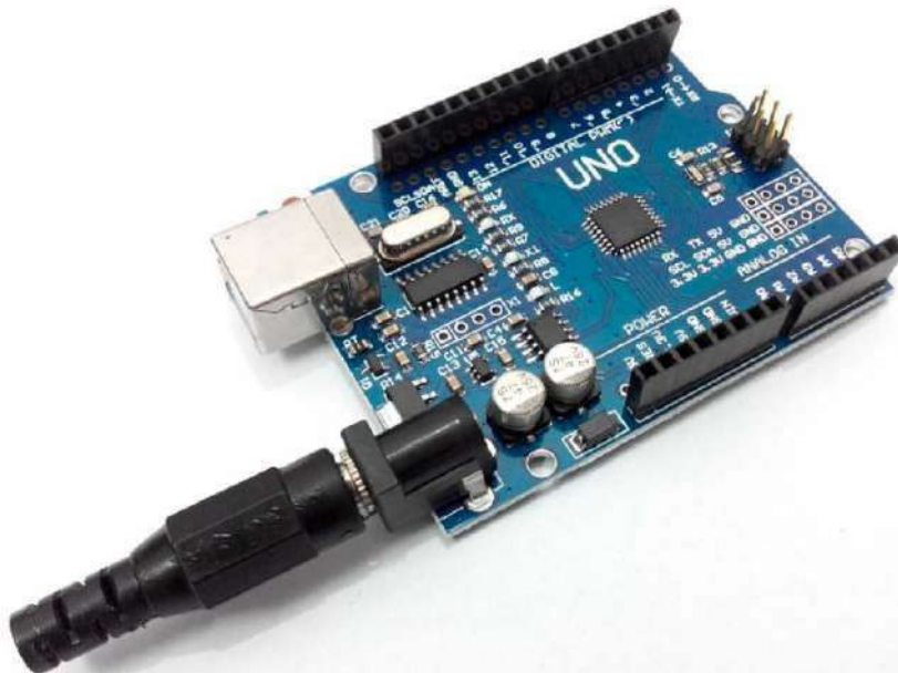
Εικόνα 6:5 Υποδοχή DC barrel power jack 5.5 x 2.1 mm Arduino.
