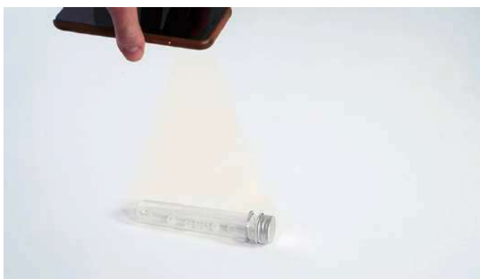
Εικόνα 8:8 Τοποθετήστε τη δεύτερη ομάδα UV χαντρών κάτω από μια εσωτερική πηγή φωτός (φως λάμπας, φλας κινητού φως από φακό κ.α.).
